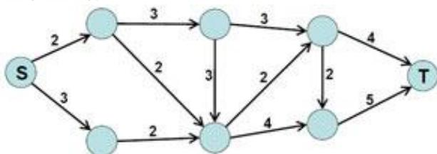
Каждая дуга графа отображает трубу. Числа над дугами (веса) - пропускная способность труб. Узлы - места соединения труб. Вода течёт по трубам только в одном направлении. Узел  $S$  - источник воды, узел  $T$  - сток. Требуется максимизировать объём воды, протекающей от источника к стоку.
