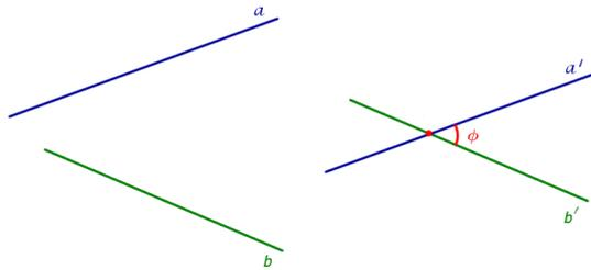
На рисунке изображены скрещивающиеся прямые  $a$  и  $b$ . Прямая  $a'$  параллельна прямой  $a$ , прямая  $b'$  параллельна прямой  $b$ . Прямые  $a'$  и  $b'$  пересекаются. Угол  $\phi$  и является углом между скрещивающимися прямыми  $a$  и  $b$ .
