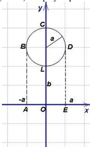
Решение. Пусть круг вращается вокруг оси  $Ox$  (рис. 20). Объём тора можно представить как разности объёмов тел, полученных от вращения криволинейных трапеций  $ABCDE$  и  $ABLDE$  вокруг оси  $Ox$ .
