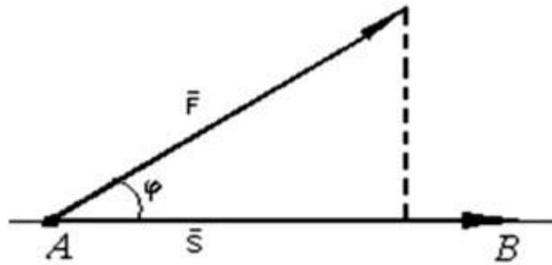
Следовательно, работа постоянной силы при прямолинейном перемещении точки ее приложения равна скалярному произведению вектора силы на вектор перемещения.
