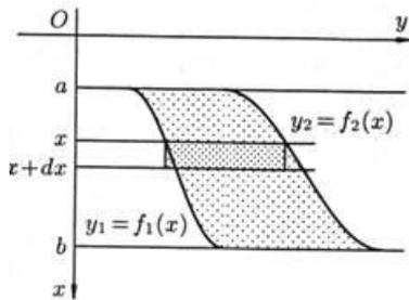
Для решения задачи разобьем пластину на  $n$  частей (малых горизонтальных полосок) прямыми, параллельными поверхности жидкости (т.е. параллельными оси  $OY$ ). На глубине  $x$  выделим одну из них и обозначим через  $f(x)$  ее длину, а через  $\Delta x$  ее ширину. Приняв полоску за прямоугольник, находим ее площадь  $S = f(x) \cdot \Delta x$ .
