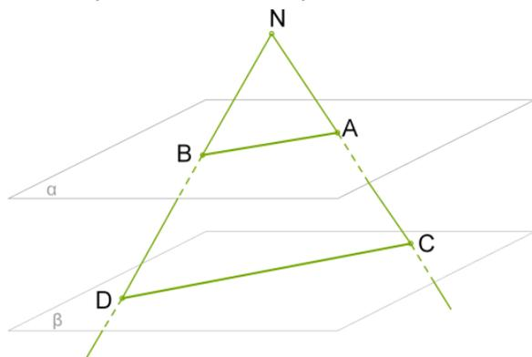
Стороны  $\triangle N$  пересекают параллельные плоскости  $\beta$  и  $\alpha$
