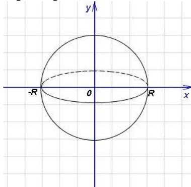
Решение. Рассмотрим шар как тело, получающееся при вращении вокруг оси абсцисс полукруга радиуса  $R$  с центром в начале координат. Тогда в формуле (1) подынтегральная функция запишется в виде  $y^2 = R^2 - x^2$ , а пределами интегрирования служат  $-R$  и  $R$ . В вычислениях радиус  $R$  считается константой (вместо него можно подставить любое значение для шара с любым радиусом). Применяем **табличный интеграл**. Следовательно,
