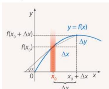
Угол наклона касательной в точке  $x_0$
