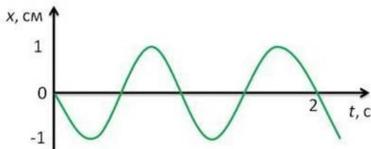
№5. По уравнению гармонических колебаний определить амплитуду, угловую скорость, период и частоту. Начертить график данного гармонического колебания.
