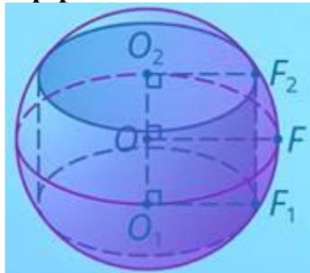
**Сфера вписана в цилиндр**, если она касается его оснований в его центрах, а боковой поверхности по большому кругу, параллельному основанию цилиндра (несложно доказать, что в этом случае радиусы сферы и цилиндра совпадают, а высота цилиндра равна диаметру сферы).
