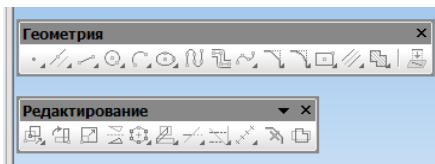
Рис. 5 Панели инструментов Геометрия и Редактирование (2Д)
