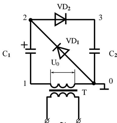
Рисунок 6.1 – Схема одной ступени каскадного выпрямителя
