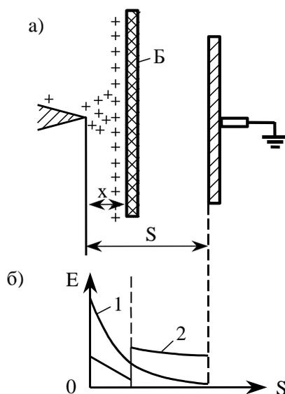
Рисунок 2.2 – Барьер (а) и напряженность электрического поля (б) в промежутке острие-плоскость: 1- без барьера; 2 - с барьером
