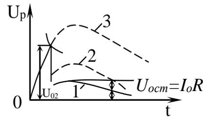
Рисунок 5.3 – Определение остающегося напряжения разрядника
