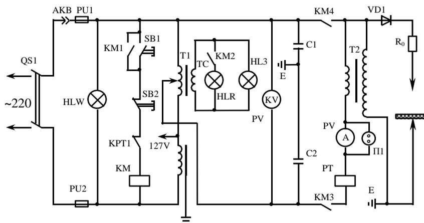
Рисунок 2.4 – Принципиальная схема выпрямительной установки:
