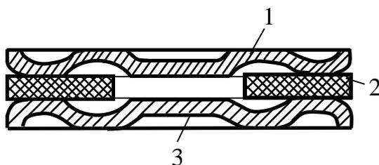
Рисунок 5.6 – Единичный искровой промежуток с неподвижной дугой
