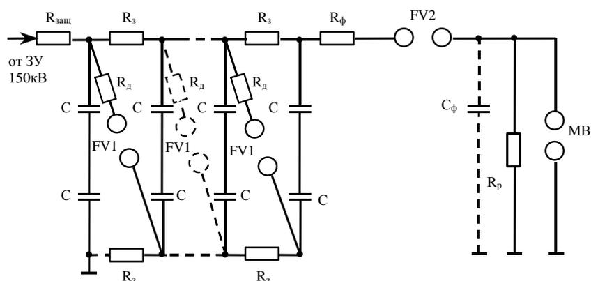
Рисунок 7.3 – Принципиальная схема генератора 750 кВ
