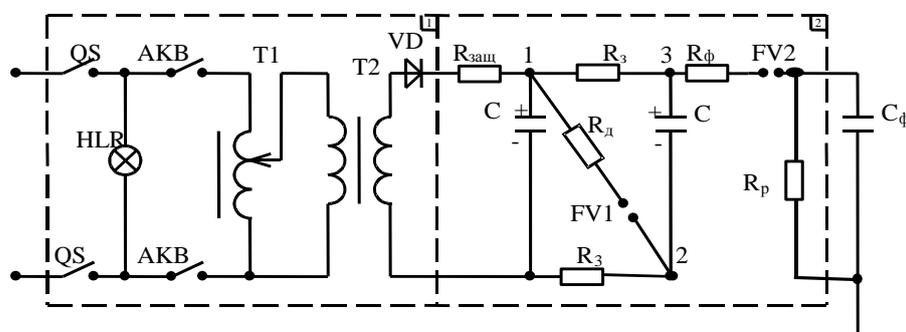
Рисунок 7.2 – Схема ГИН
