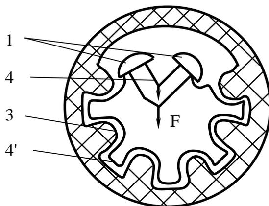
Рисунок 5.8 – Искровой промежуток с растягивающейся дугой
