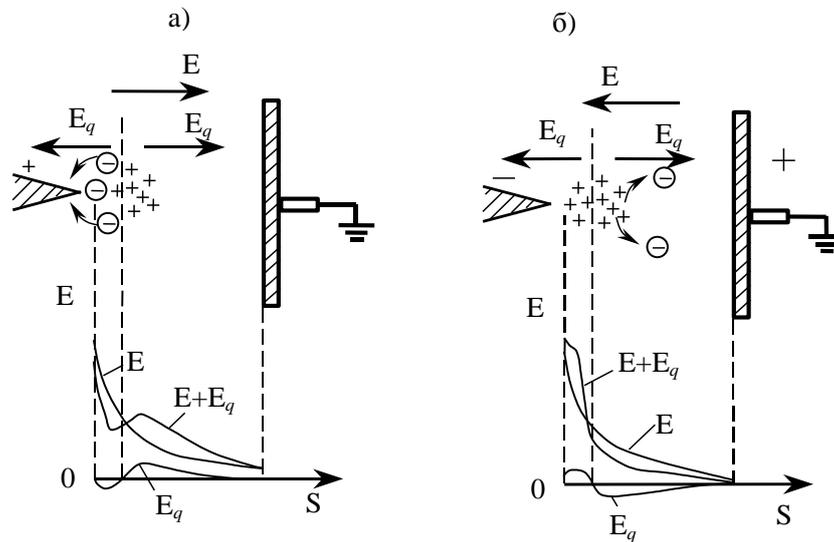
Рисунок 2.1 – Напряженность электрического поля в промежутке острие-плоскость:  $E$  - без учета влияния объемных зарядов;  $E_q$  - создаваемая положительными объемными зарядами;  $E+E_q$  – результирующая
