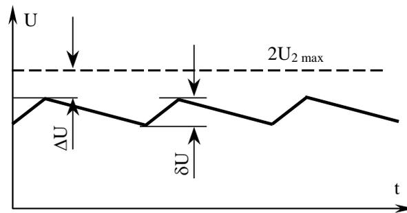
Рисунок 6.3 – Падение напряжение и напряжение пульсаций для схемы
