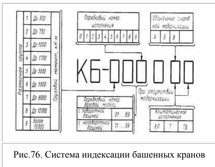
Рис.76. Система индексации башенных кранов
