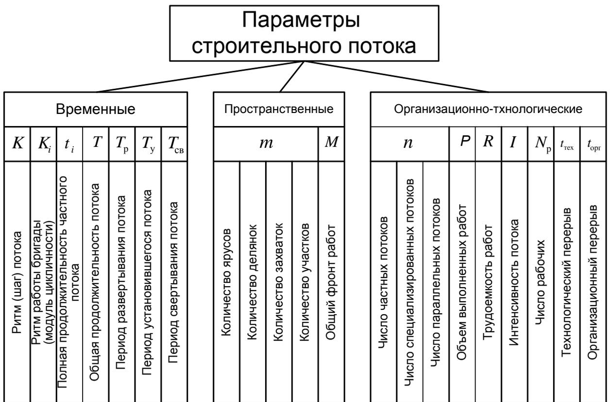
Рисунок 3.3 Классификация и обозначение параметров строительных потоков
