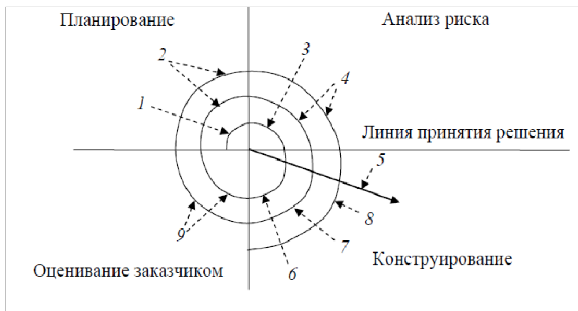
Рисунок 1.11 - Спиральная модель: 1 – начальный сбор требований и планирование проекта; 2 – та же работа, но на основе рекомендаций заказчика; 3 – анализ риска на основе начальных требований; 4 – анализ риска на основе реакции заказчика; 5 – переход к комплексной системе; 6 – начальный макет системы; 7 – следующий уровень макета; 8 – сконструированная система; 9 – оценивание заказчиком
