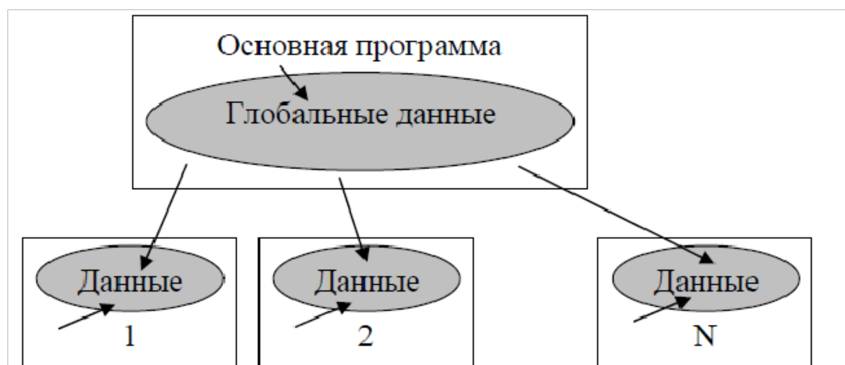
Рисунок 1.4 - Принцип работы программы, использующей подпрограммы с локальными данными
