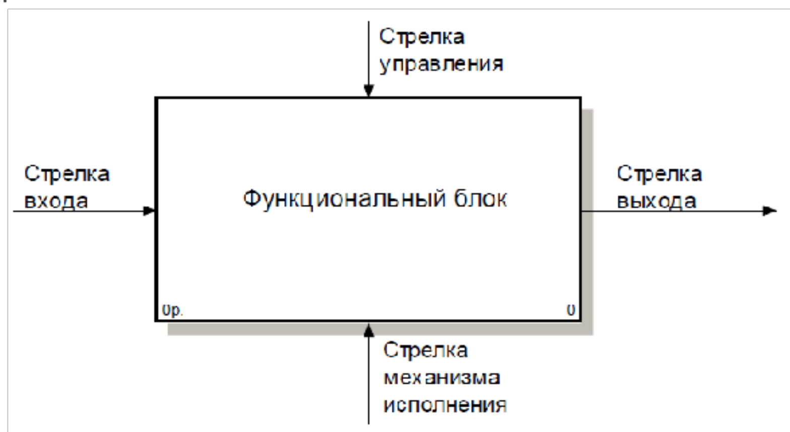
Рисунок 2.19 - Соединение стрелок со сторонами функционального блока
