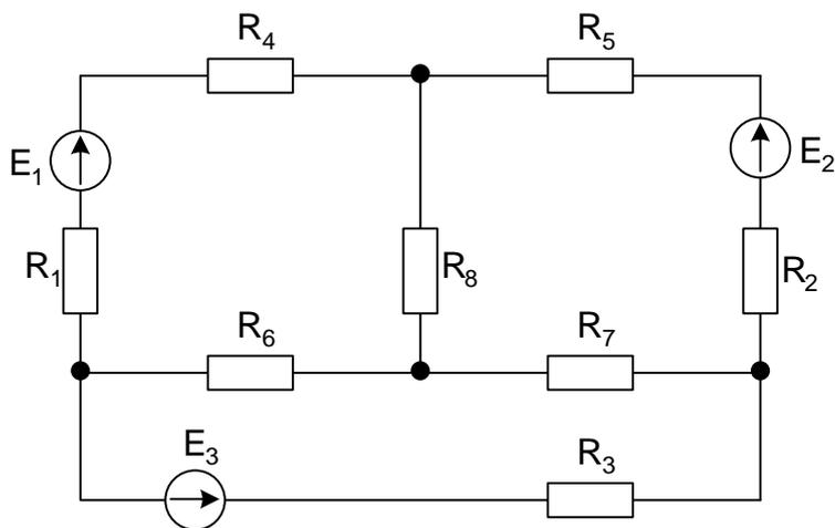
Рис. 1. Схема электрическая принципиальная к вариантам 1...10
