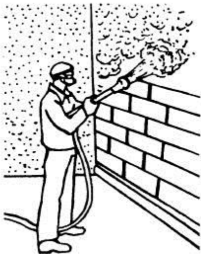
Рисунок 5 - Последовательное нанесение слоев обрызга, грунта
