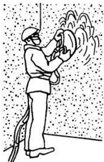
Рисунок 8 – Механизированная затирка поверхности
