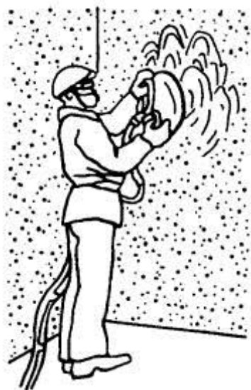
Рисунок 8 – Механизированная затирка поверхности
