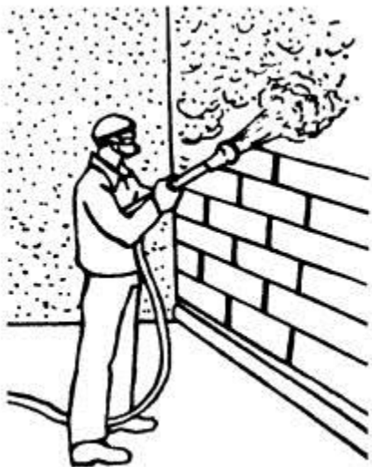
Рисунок 5 - Последовательное нанесение слоев обрызга, грунта
