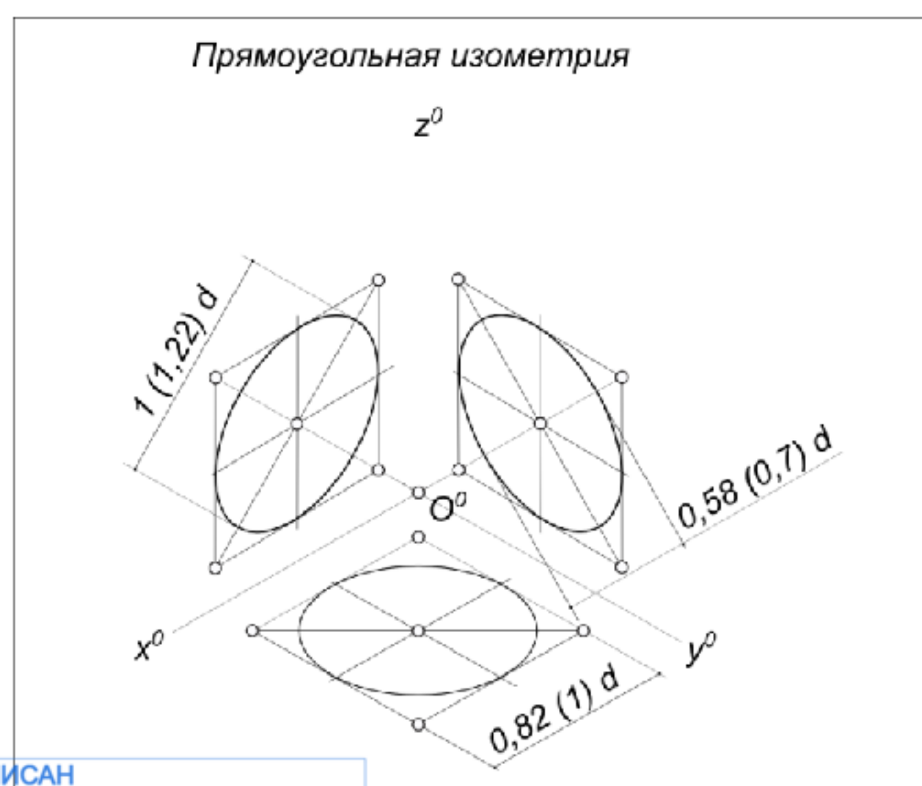
Рис.4. Прямоугольная и изометрические проекции круга
