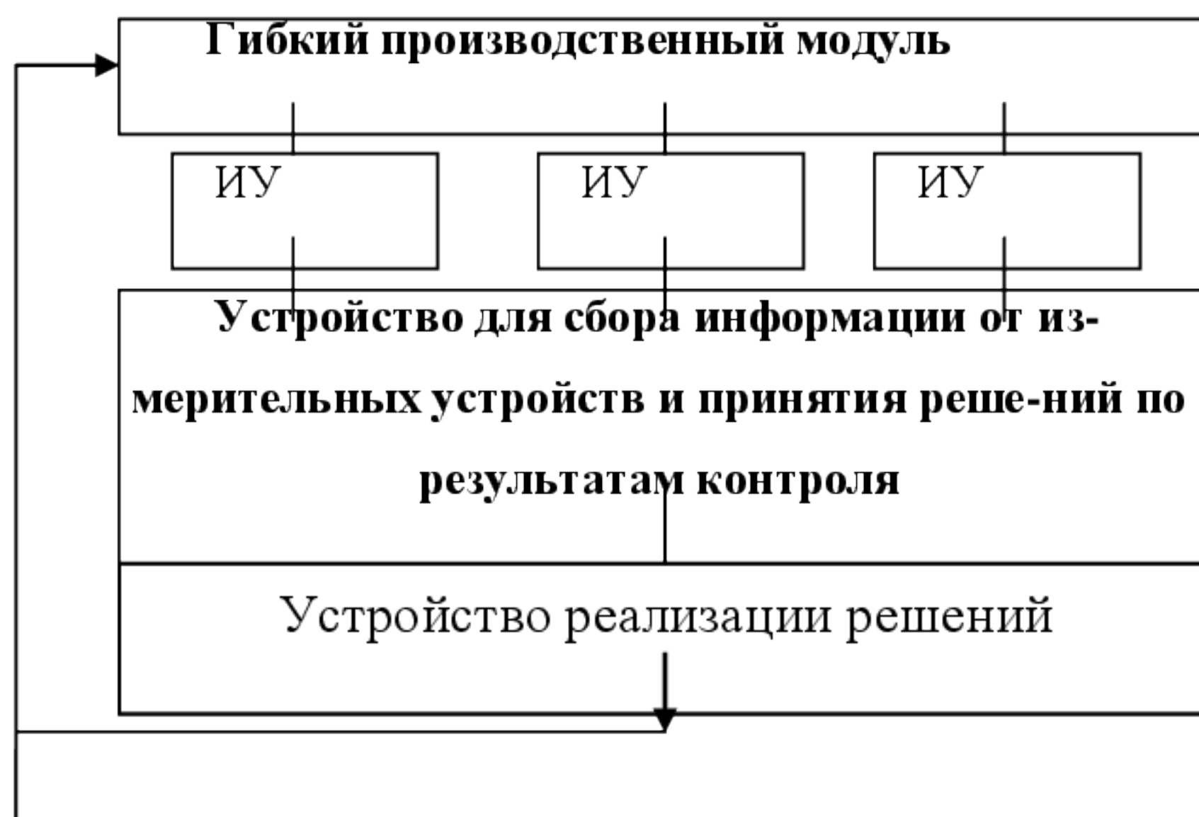
Рис. 9.2. Структура средств диагностирования и контроля (ИУ - измерительное устройство).
