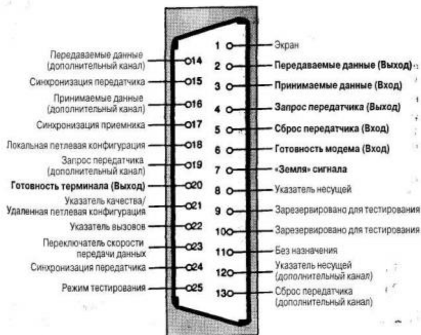
Рисунок 3.- Назначение контактов Сом порта.
