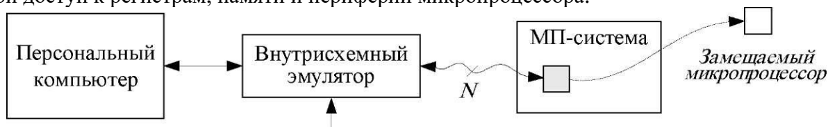
Рис. 33.2. Отладка с помощью внутрисхемного эмулятора N - количество выводов процессора
