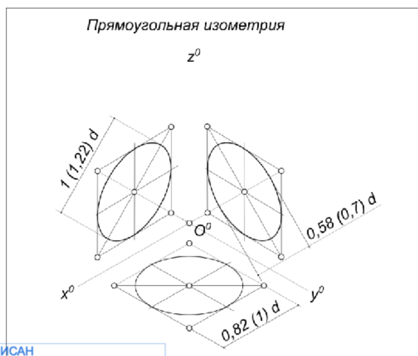
Рис.4. Прямоугольная и изометрические проекции круга
