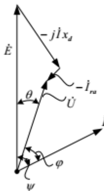
Рисунок 8.3 – Векторная диаграмма неявнополюсного СГ
