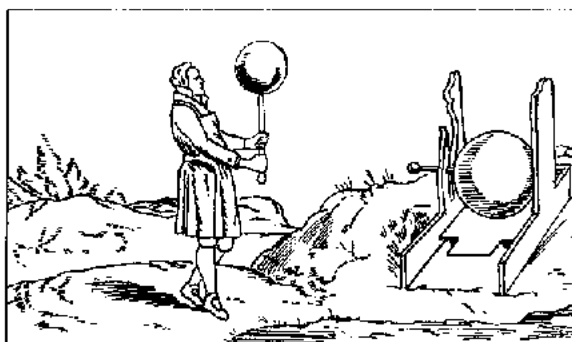
Рисунок 4. Электростатическая машина Герике
