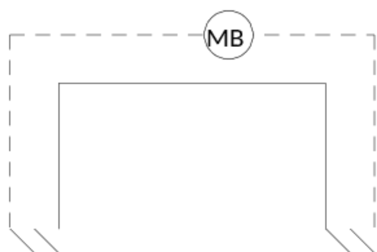
Рис. 1. Схема измерения показаний термопары с помощью милливольтметра
