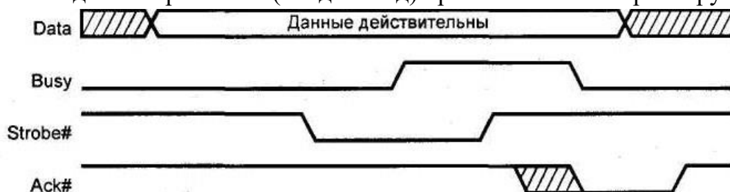
Рис. 3.1 – Передача данных по протоколу Centronics
