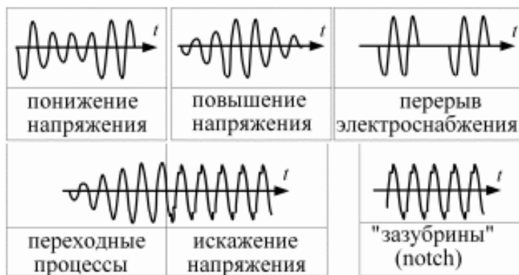
Рисунок 1 – Основные случаи ухудшения качества электроэнергии
