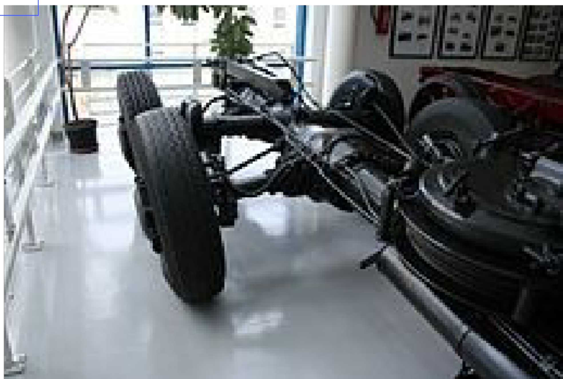
Рис.7.2. Хребтовая рама грузовика «Татра»
