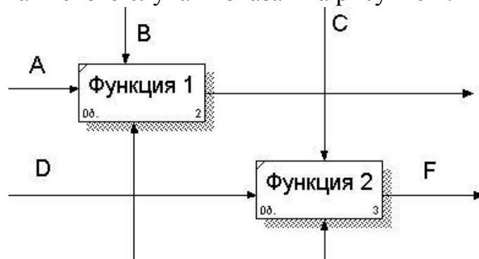
Рис. 2. Пример функциональной диаграммы, где функция 1 и функция 2 связаны случайной связью
