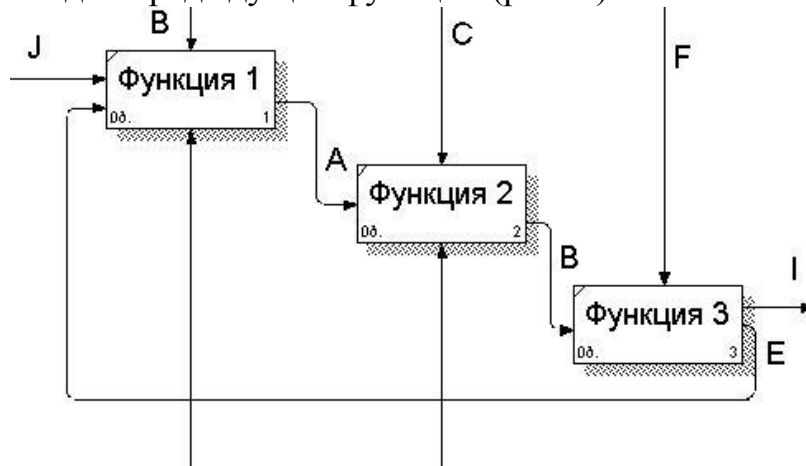
Рис. 6. Пример функциональной диаграммы, где связь Е обратная
