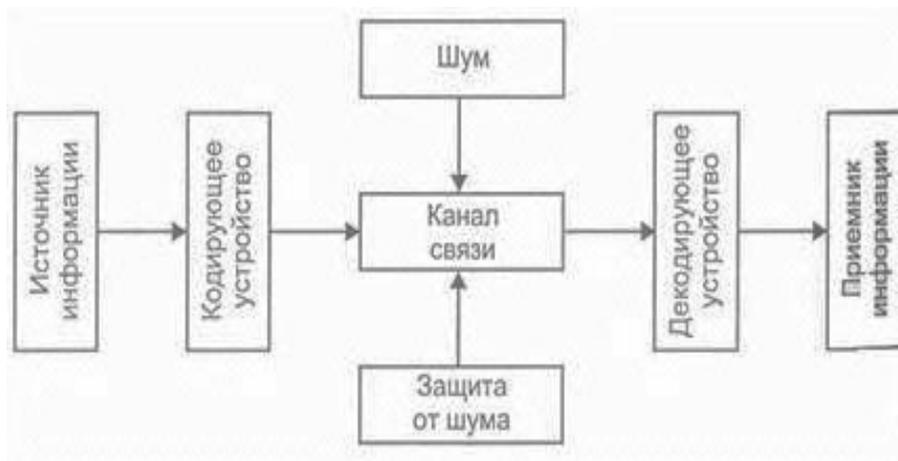
В качестве источника информации может выступать живое существо или техническое устройство. От него информация попадает в кодирующее устройство, которое предназначено для преобразования исходного сообщения в форму, удобную для передачи. С такими устройствами вы встречаетесь постоянно: микрофон телефона, лист бумаги и т.д.
