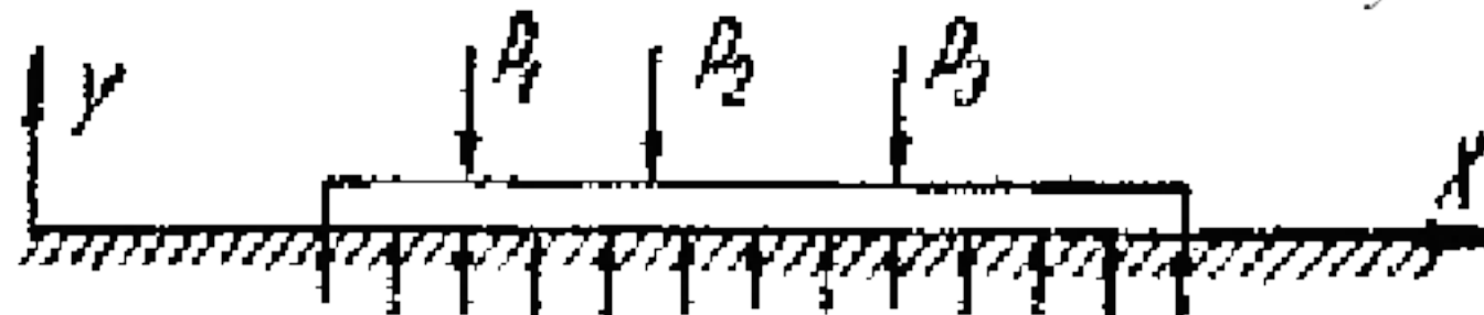
Рис.1. Расчетная схема балки на упругом основании.
