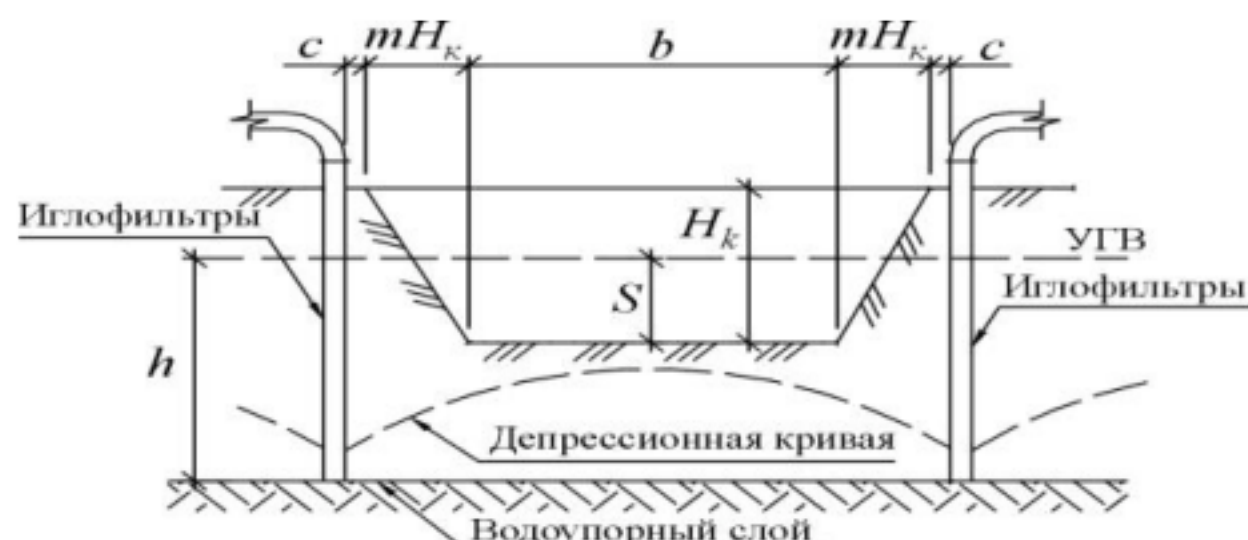
Рис. 6. Схема для расчета иглофильтровой установки
