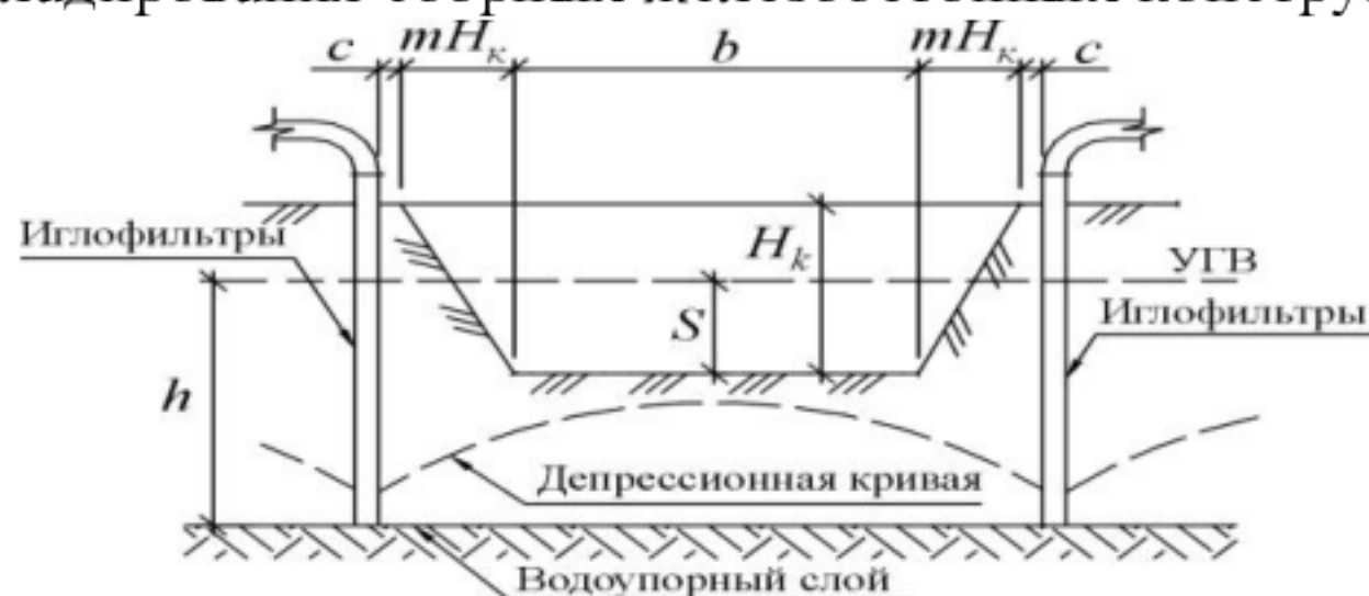
Рис. 6. Схема для расчета иглофильтровой установки
