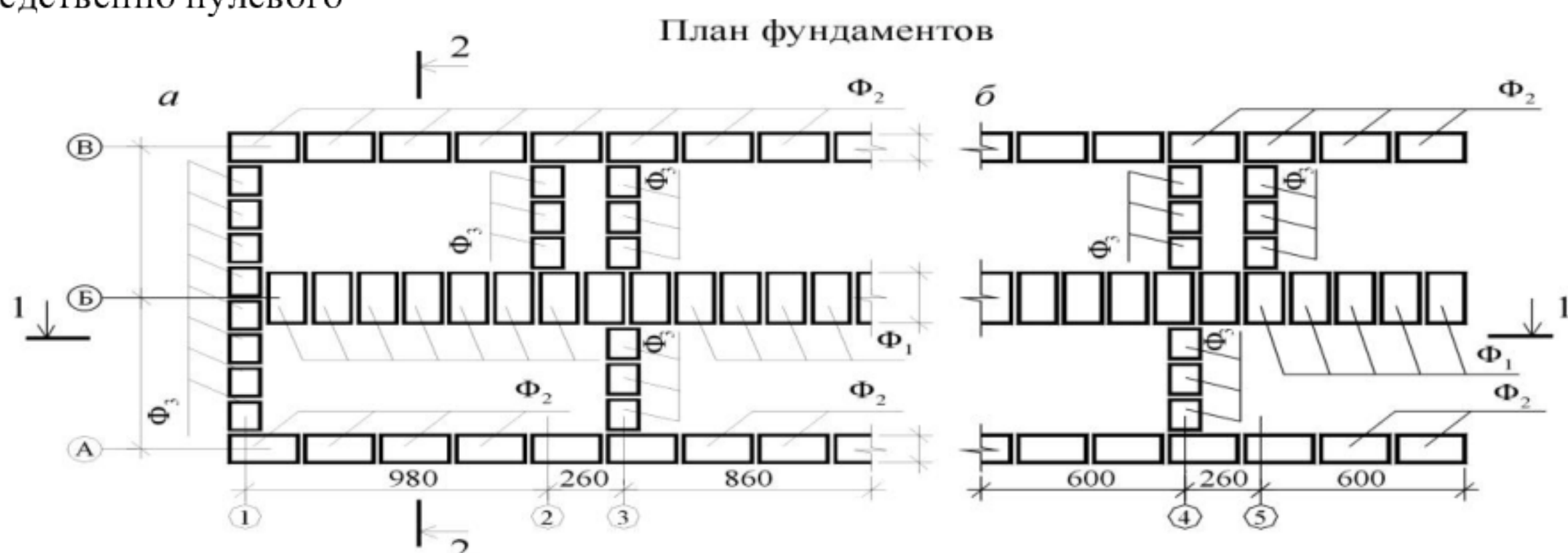
Рис. 1. Планы фундаментов и раскладки плит перекрытия над подвалом: а – для торцевой блок-секции; б – для рядовой блок-секции
