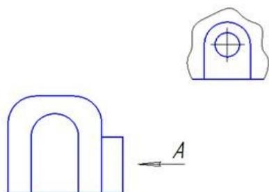
141. При выполнении разреза секущая плоскость обозначается ...(*разомкнутой*) утолщенной линией
