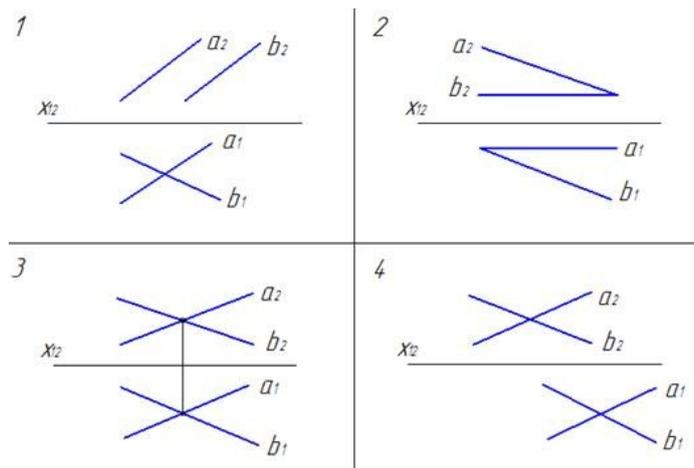
60. На чертеже плоскость проекций ... (III) была заменена на новую для того, чтобы плоскость общего положения стала проецирующей:
