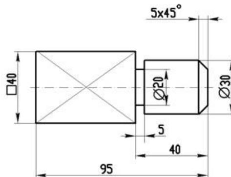
25. Специальный знак  $\varnothing$  используют для нанесения размеров ... (окружностей)
