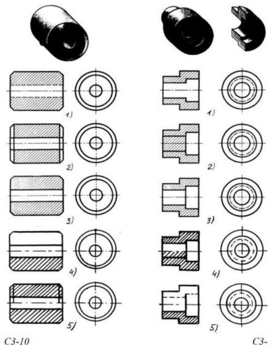
126. Разрез детали на рисунке СЗ-11 показан под цифрой:
