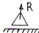
Реакцию шарнирно-подвижной опоры разложить на две составляющие, направленные по осям координат
