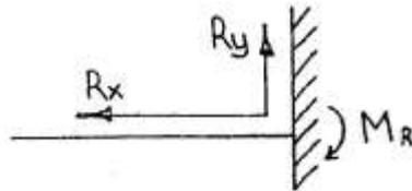
4. Составить расчетную схему балки.
