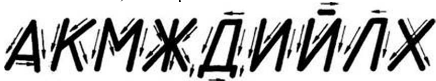
рис. 1.3. Начертание прописных букв, состоящих из горизонтальных, вертикальных и наклонных элементов
