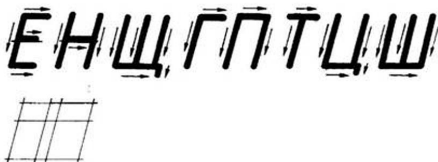
Рис. 1.2. Начертание прописных букв, состоящих из горизонтальных и вертикальных элементов, и построение вспомогательной сетки
