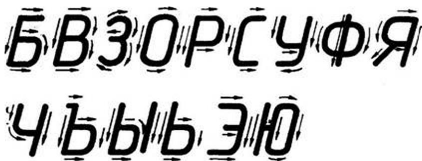
Рис. 1.4. Начертание прописных букв, состоящих из прямолинейных и криволинейных элементов
