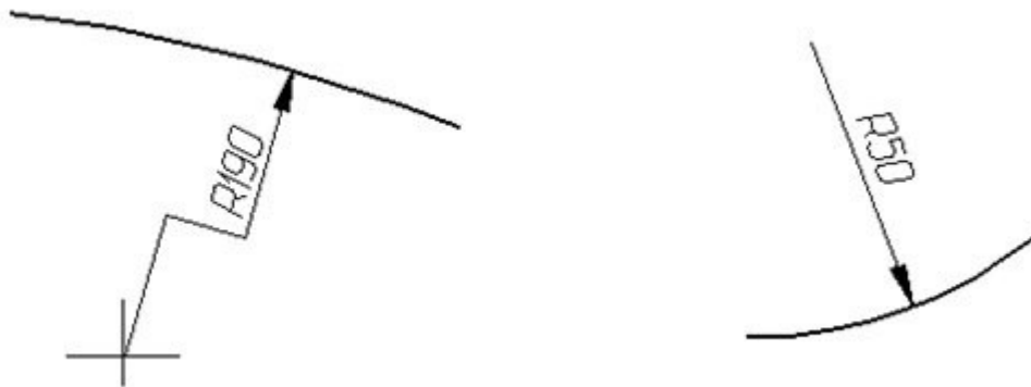
Рисунок 2.17 - Примеры нанесения размера радиуса
