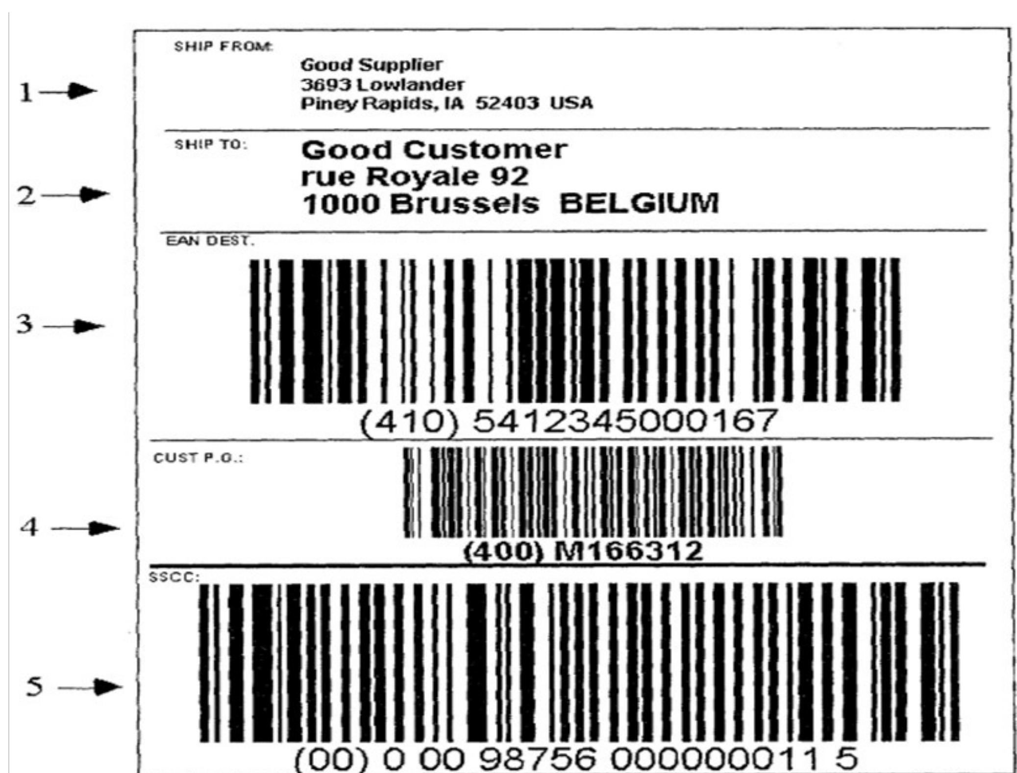
Рис. 2.10. Основная этикетка, содержащая уникальный идентификатор транспортируемой единицы в символике UCC/EAN и ссылки к базам данных перевозчика и заказчика: 1 – текстовая информация об отправителе; 2 – текстовая информация о получателе; 3 – ссылка к базе данных перевозчика (идентификатор применения 410 – доставить получателю с последующим кодом); 4 – ссылка к базе данных получателя (400 – номер заказа); 5 – уникальный идентификатор транспортируемой единицы.
