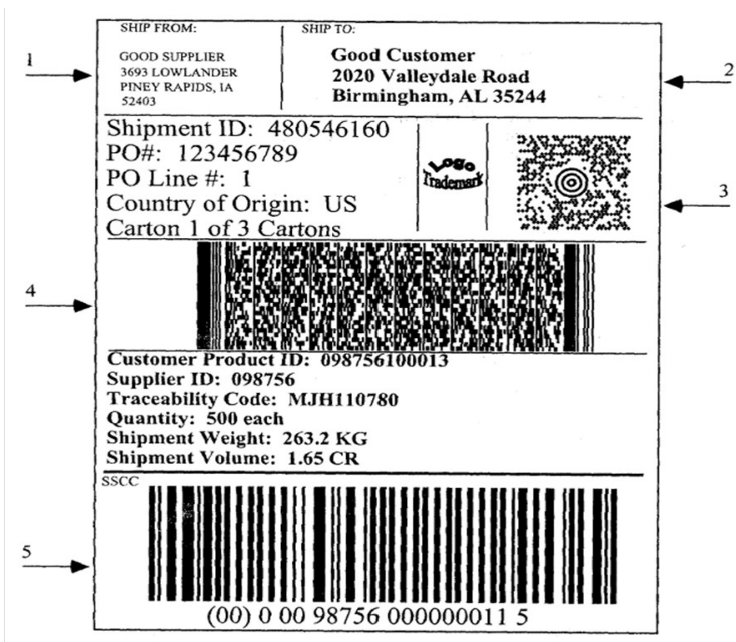
Рис. 2.14. Расширенная этикетка, содержащая уникальный идентификатор транспортируемой единицы в символике USS/EAN-128 и дополнительные данные торговых партнеров в двумерных символах: 1 – текстовая информация об отправителе; 2 – текстовая информация о получателе; 3 – двумерный символ для сортировки и/или отслеживания груза перевозчиком; 4 – двумерный символ с данными получателя или заказчика; 5 – уникальный идентификатор транспортируемой единицы в символике USS/EAN-128.
