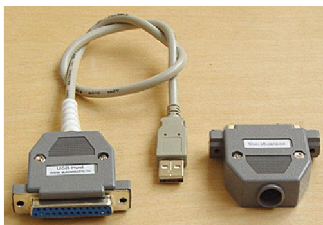
Рис. 5. Кабель для соединения адаптера с персональным компьютером
