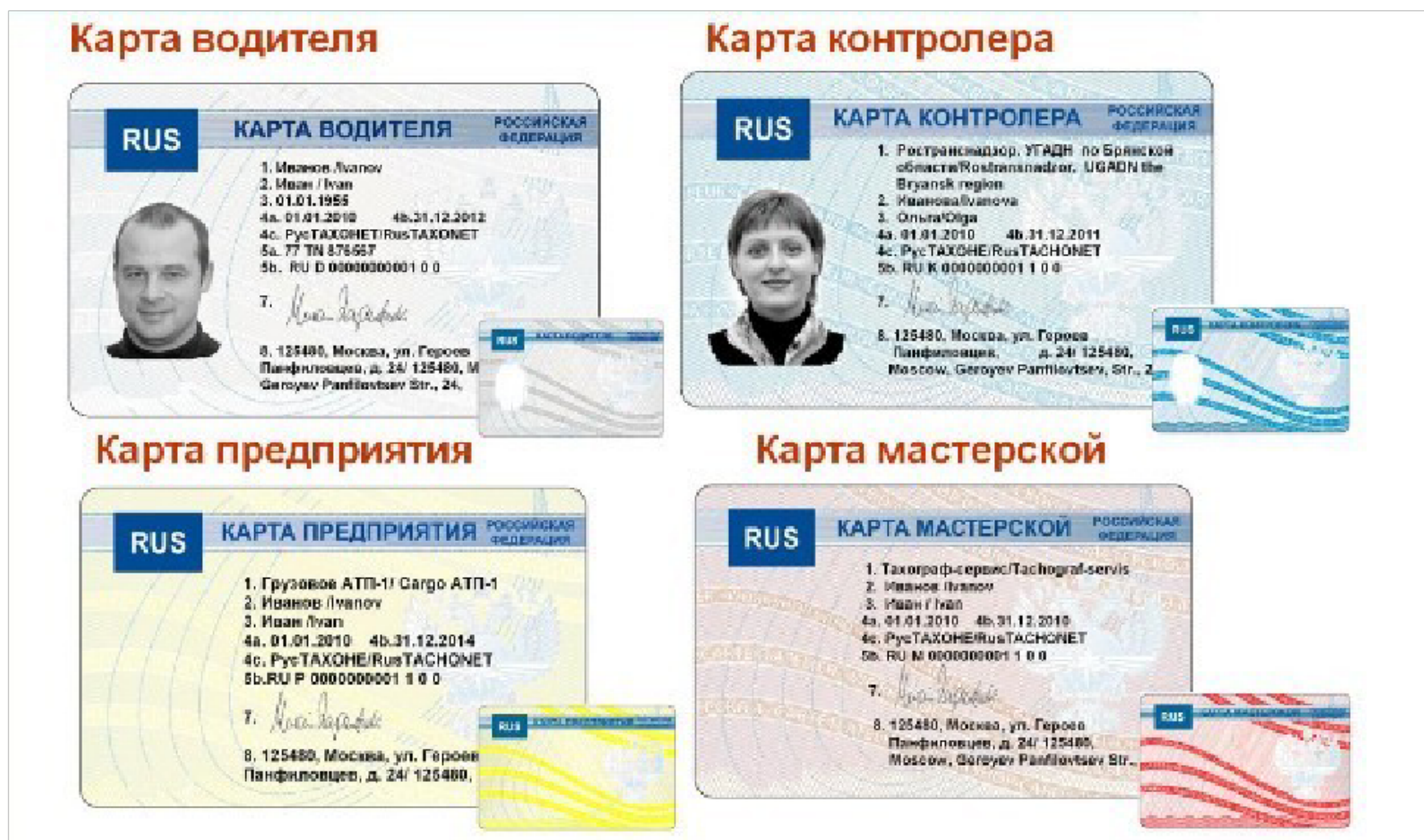
Рис. 6.3. Смарт карты для цифровых тахографов
