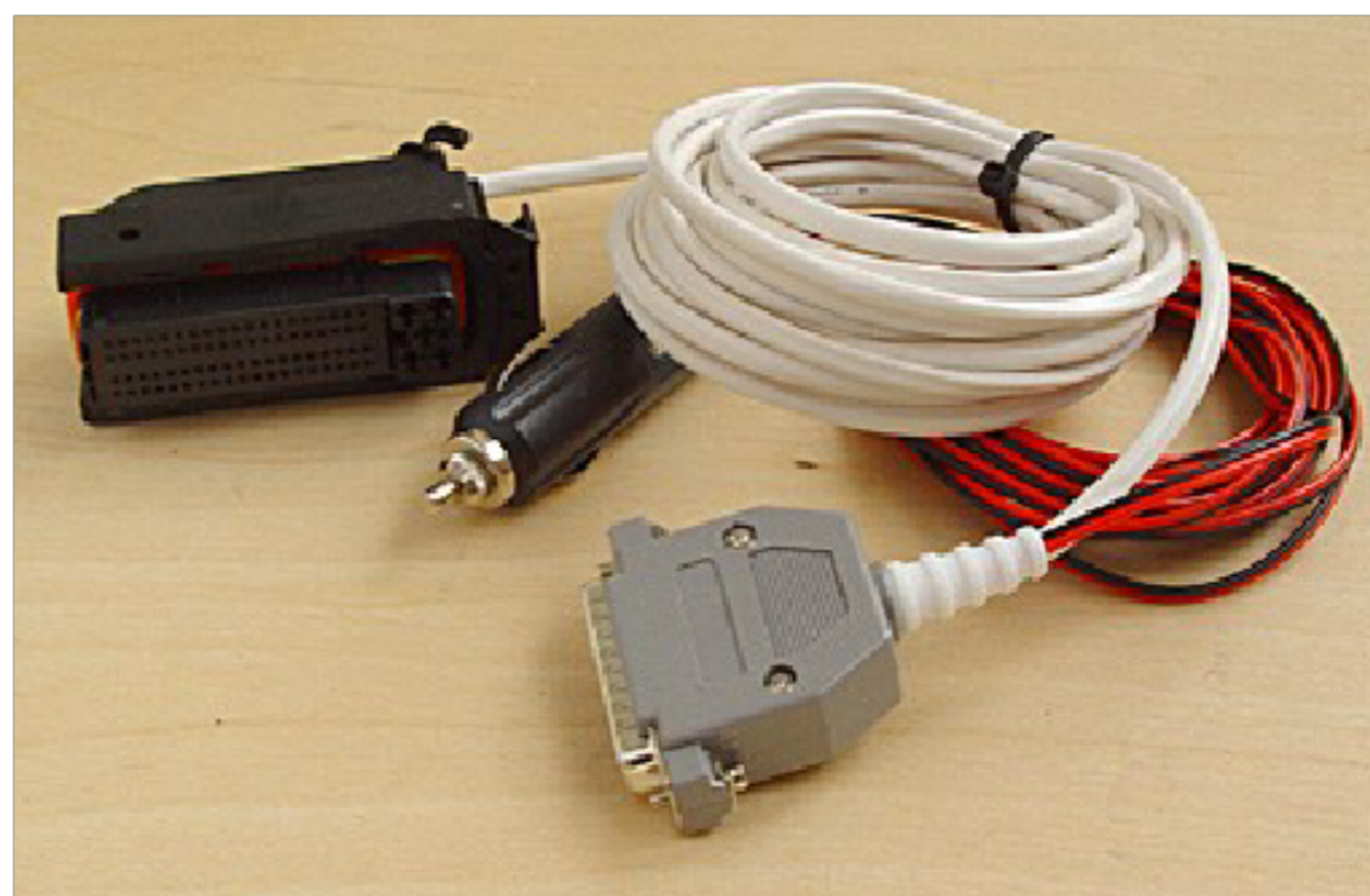
Рис. 7. Кабель для соединения адаптера с разъемами ЭБУ, имеющими 81 контактов.
