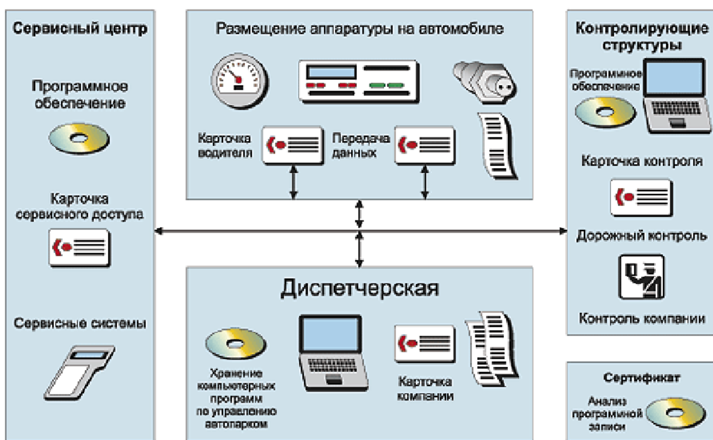
Рис. 6.5. Типовые виды чип-карт и их принадлежность
