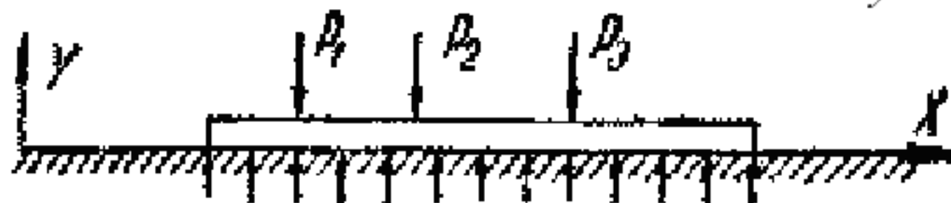
Рис.1. Расчетная схема балки на упругом основании.
