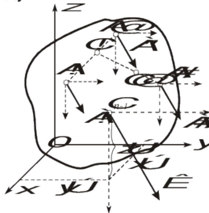
Рис. 1.37 Определение положения центра параллельных сил
