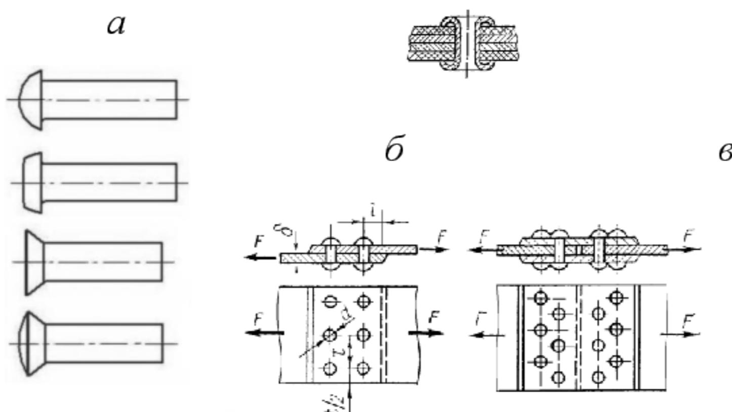
Рис. 1.15 Заклепки и заклепочные соединения
