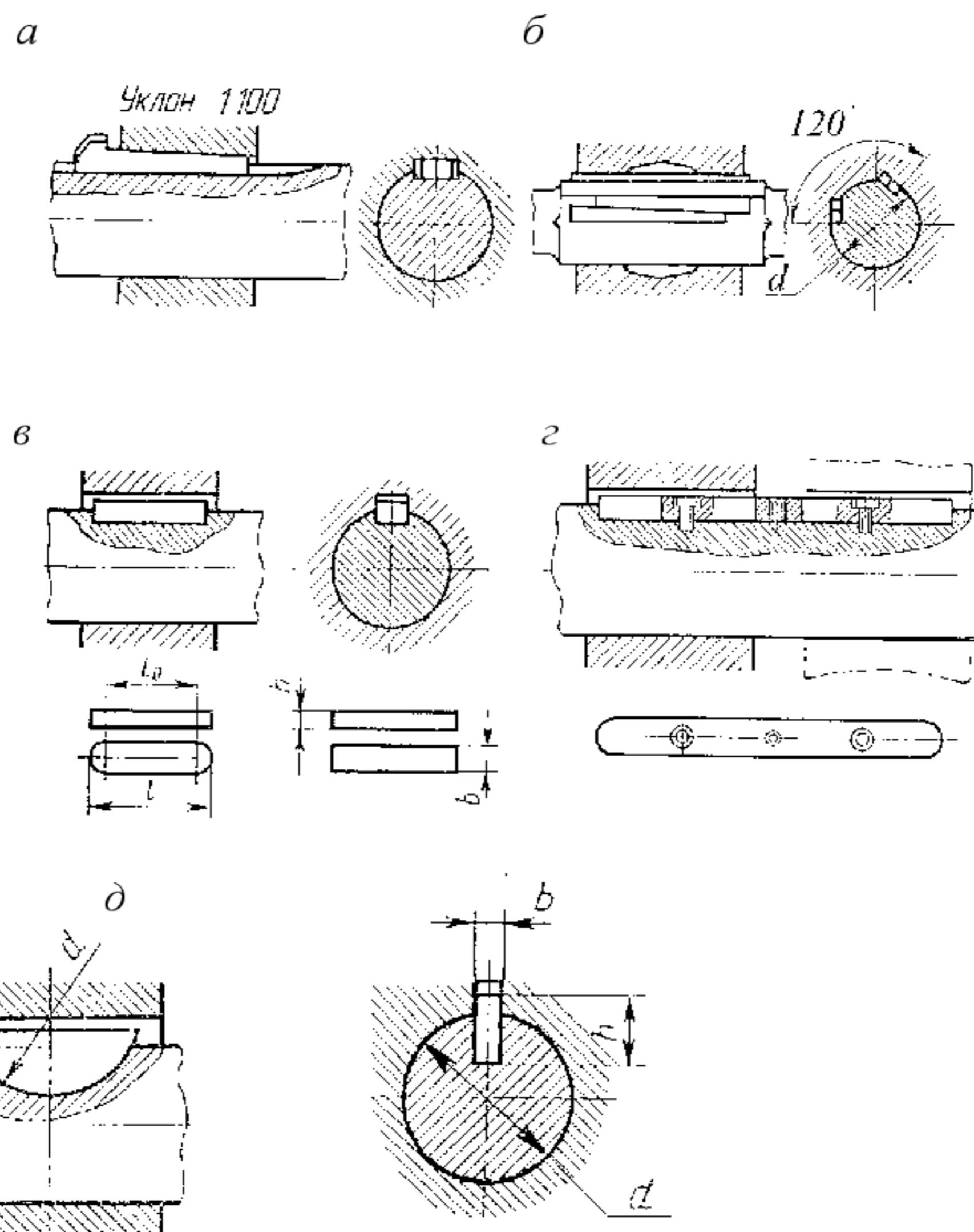
Рис. 1.25. Шпоночные соединения
