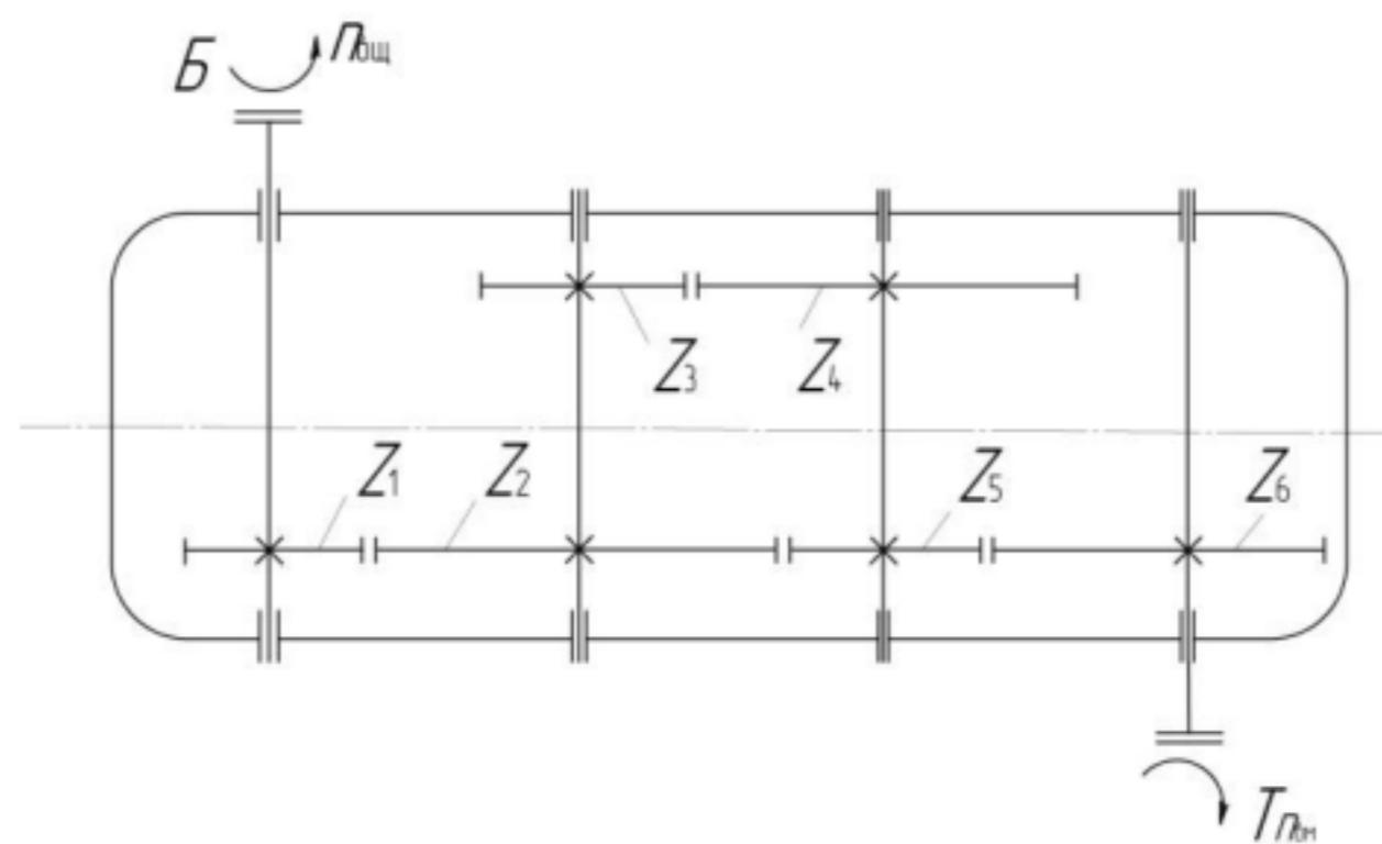
Рис. 1.6. Кинематическая схема 3 – ступенчатой зубчатой передачи (редуктора)
