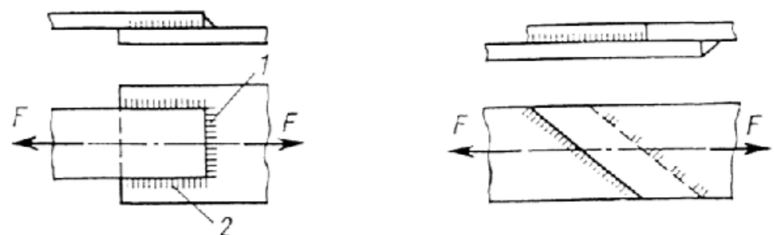
Рис. 1.17. Сварные соединения
