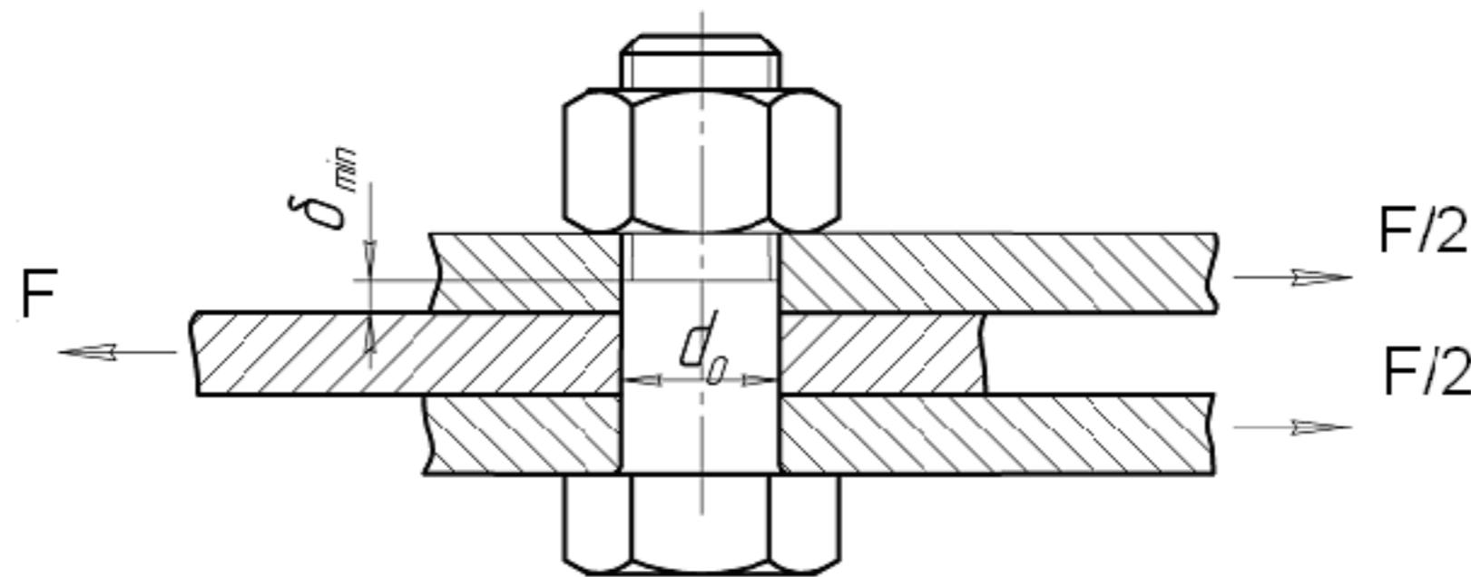
Рис. 1.23. Расчетная схема болтового соединения
