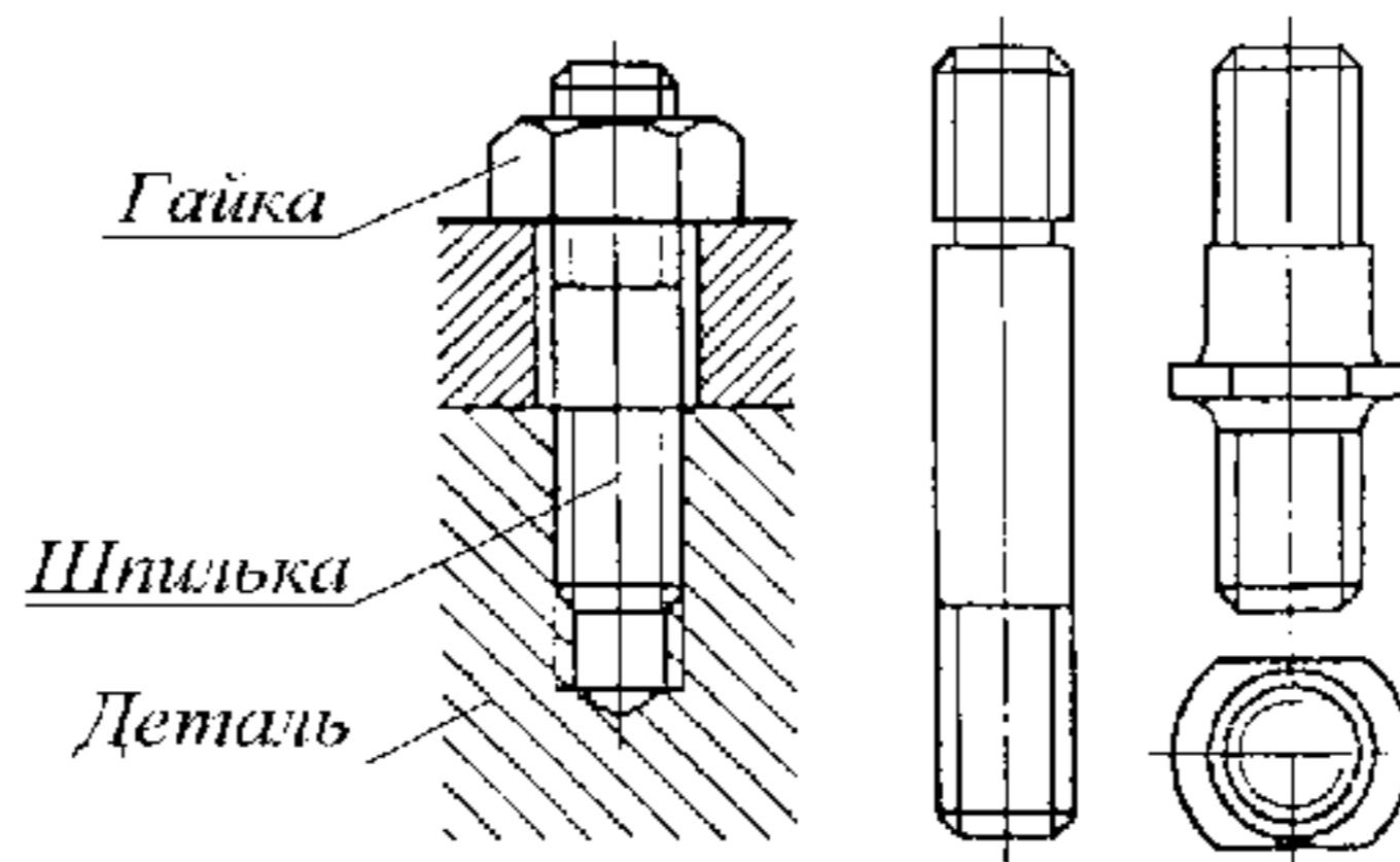
Рис. 1.21. Шпильки
