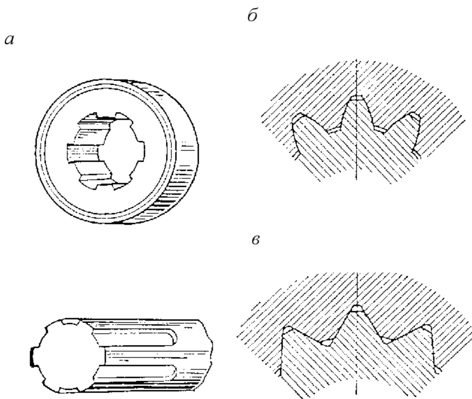
Рис. 1.27. Зубчатые соединения
