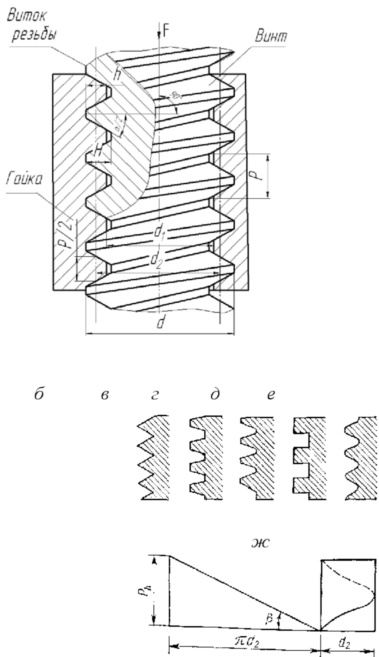
Рис. 1.19. Резьбовые соединения
