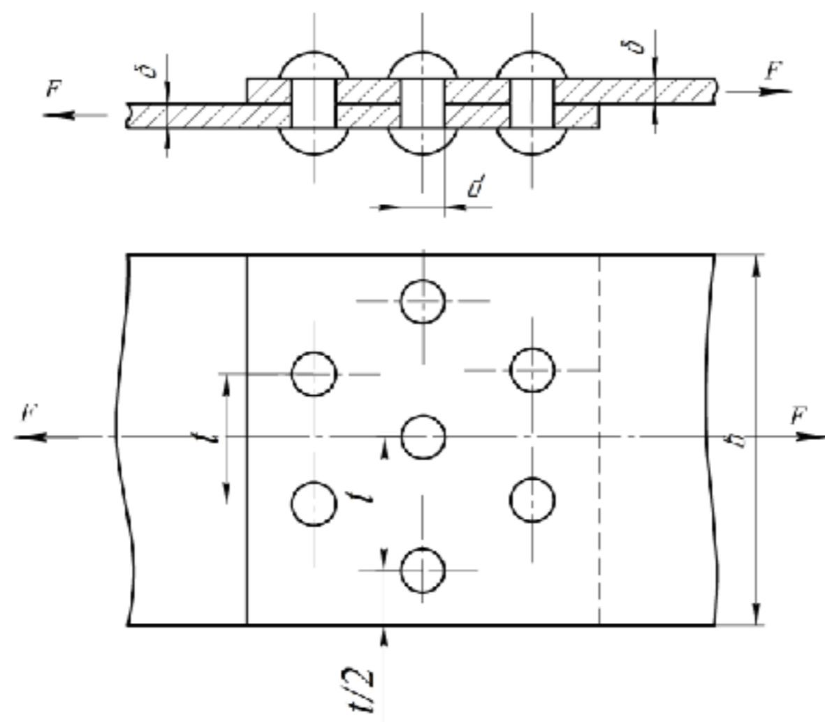
Рис. 1.16. Расчетная схема заклепочного соединения
