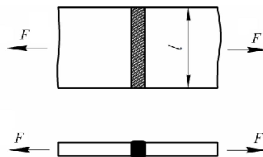
Рис. 1.18. Расчетная схема сварного соединениястык
