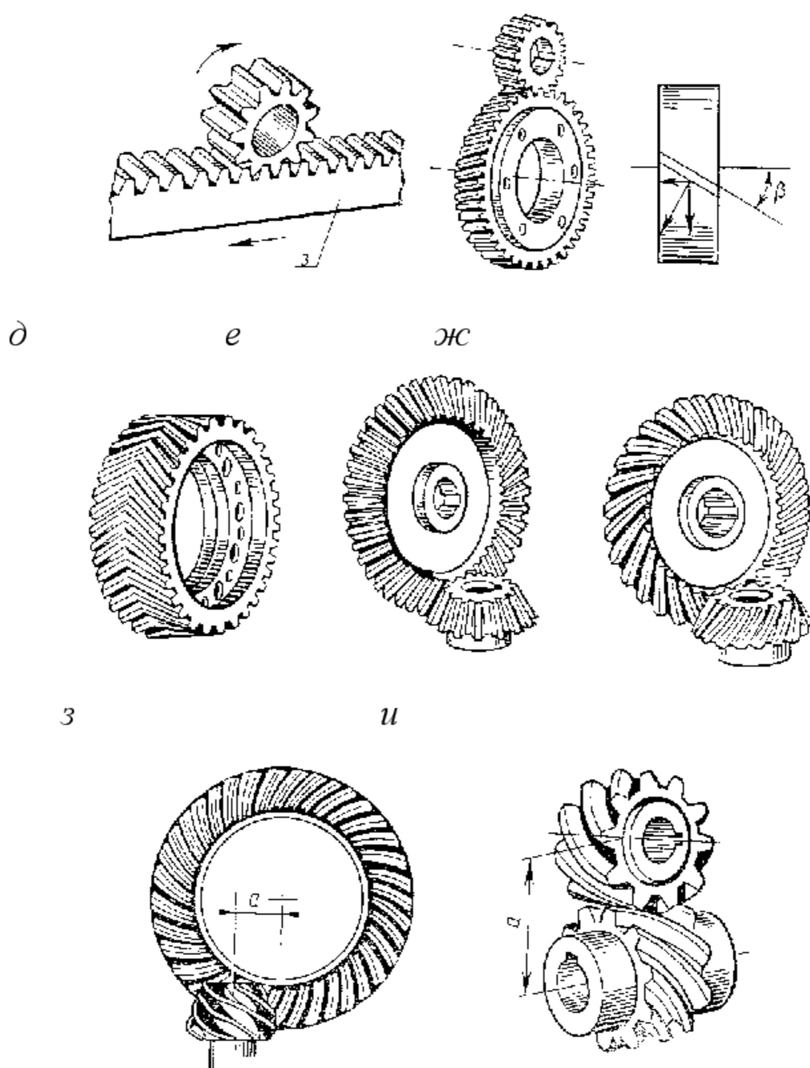
Рис. 1.4 Виды зубчатых передач: 1 – шестерная; 2 – колесо; 3 – рейка
