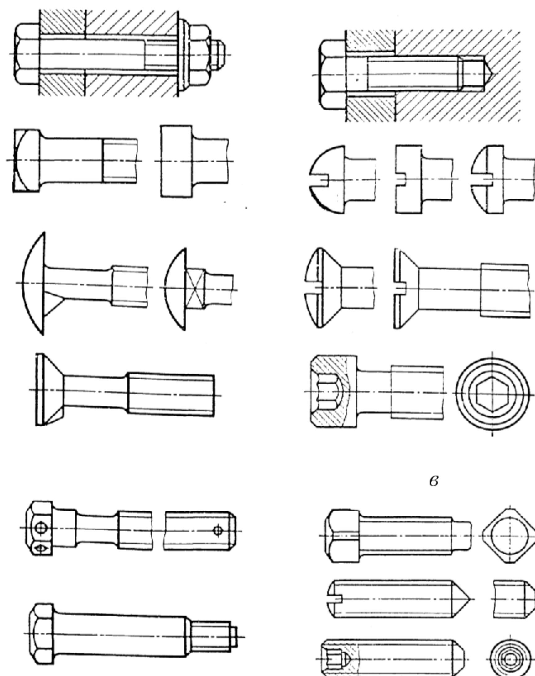
Рис. 1.20. Виды болтов и винтов
