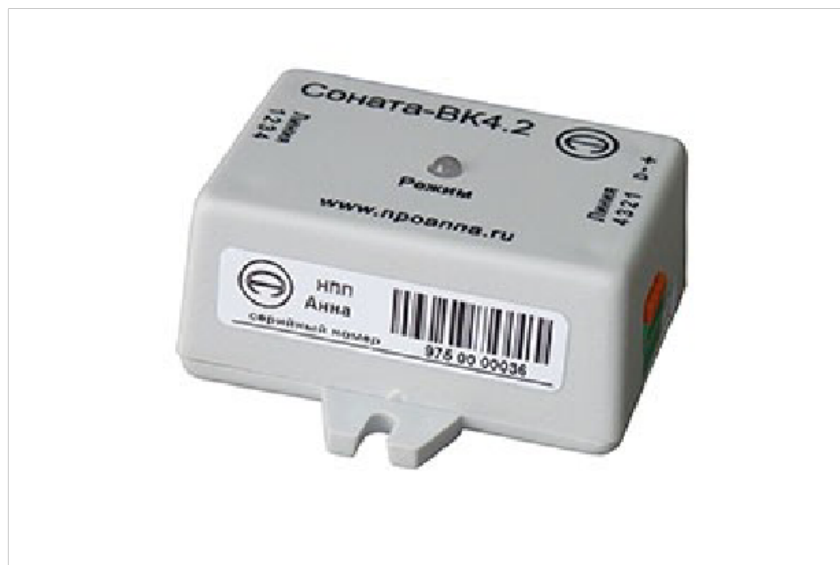
Рисунок 16 – Внешний вид устройства Соната-BK4.2
