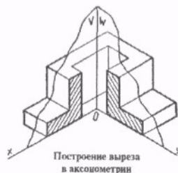
Рисунок 11.5. Построение выреза в аксонометрии.
