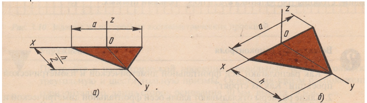
Рис. 3. Аксонометрические проекции треугольника: а — фронтальная диметрическая; б — изометрическая
