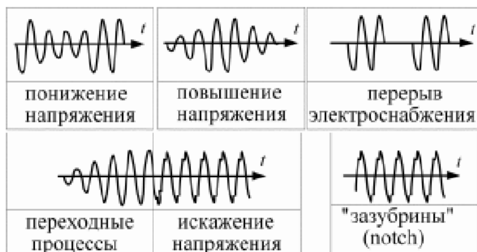
Рисунок 1 – Основные случаи ухудшения качества электроэнергии
