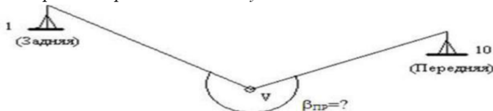
Рис. 4 Схема горизонтального «справа по ходу лежащего» угла 1-V-10
