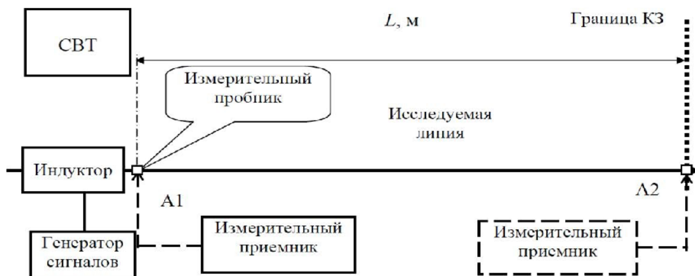
Рисунок 1 - Схема измерения реального затухания в линии
