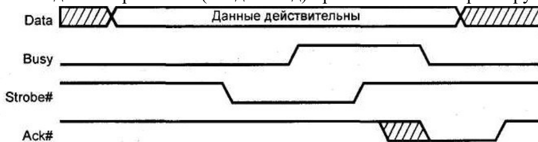
Рис. 3.1 – Передача данных по протоколу Centronics
