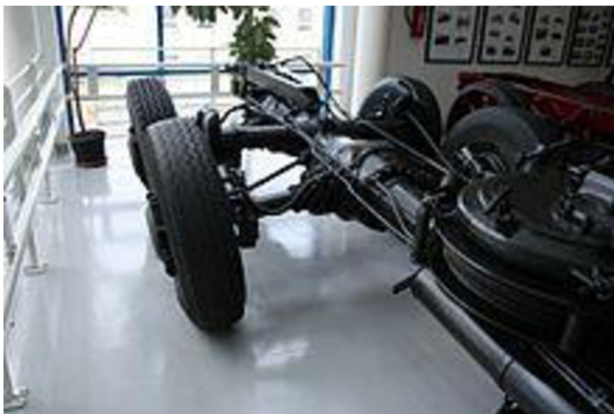
Рис.7.2. Хребтовая рама грузовика «Татра»
