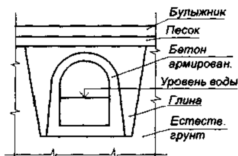
Разрез по трубе
