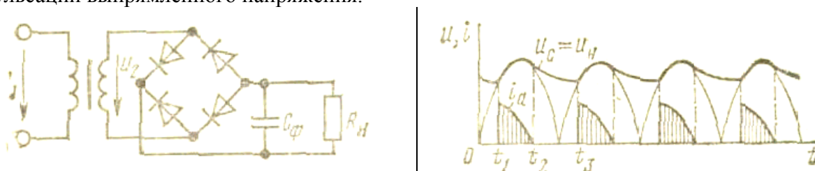
Рис.3 Двухполупериодный выпрямитель с емкостным фильтром
