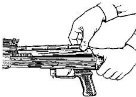
Рис. 13. Отделение крышки ствольной коробки
