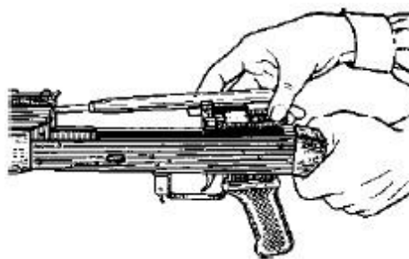
Рис. 15. Отделение затворной рамы с затвором
