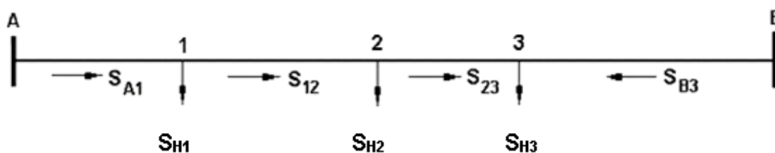
Рисунок 14.2 – Представление принципиальной схемы сети кольцевого типа сетью с двухсторонним питанием
