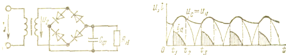
Рис.3 Двухполупериодный выпрямитель с емкостным фильтром
