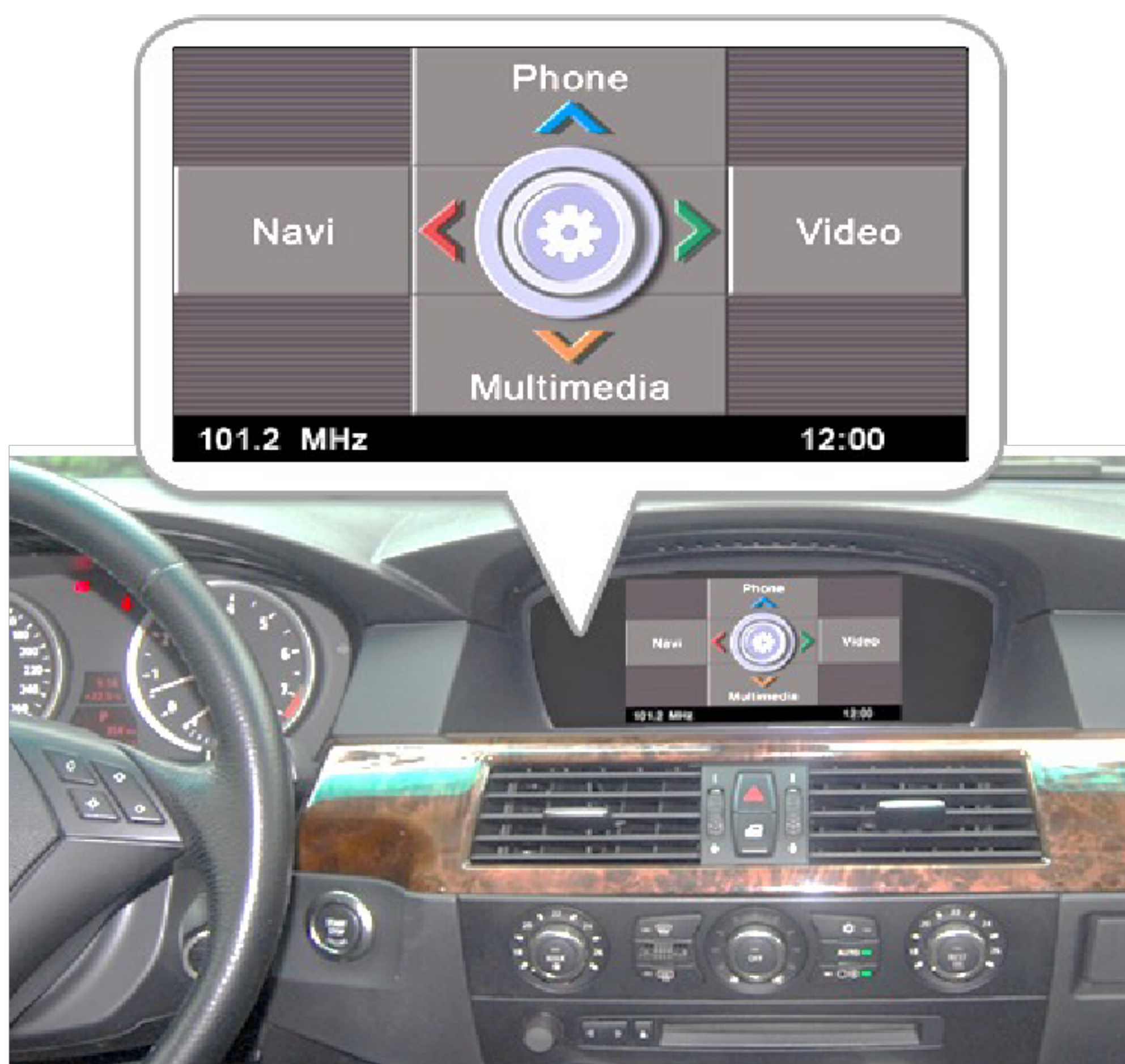
Рисунок 1 - Бортовой компьютер с жидкокристаллическим дисплеем автомобиля BMW (система CCC – Car Communication Computer)
