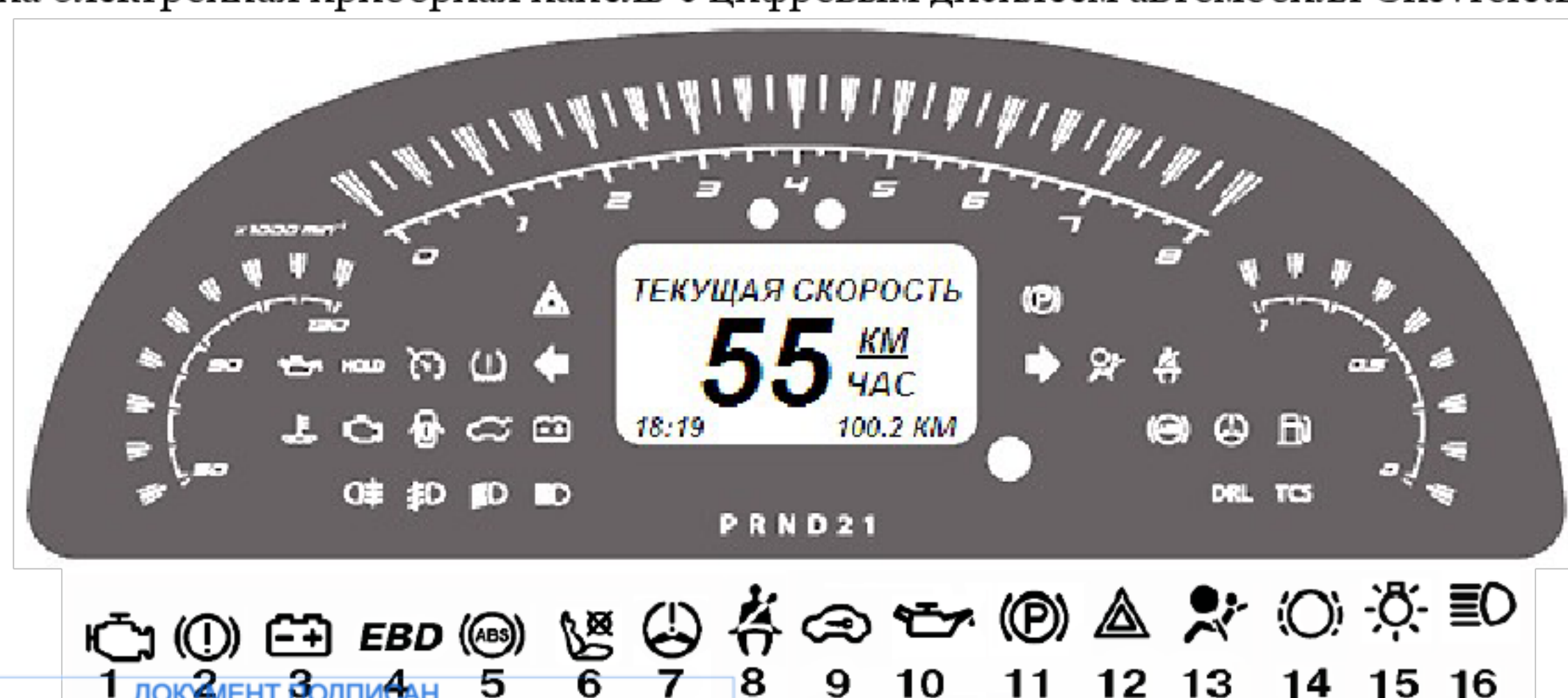
Рисунок 3 –Цифровой дисплей без стрелочных указателей одной из моделей ChevroletLacetti: 1 - Сигнализатор «Check-Engine»; 2 - Сигнализатор аварийного состояния рабочей тормозной системы; 3 - Сигнализатор разряда АКБ; 4 - Сигнализатор неисправности электронного распределения тормозных сил; 5 - Сигнализатор неисправности ABS; 6 -
