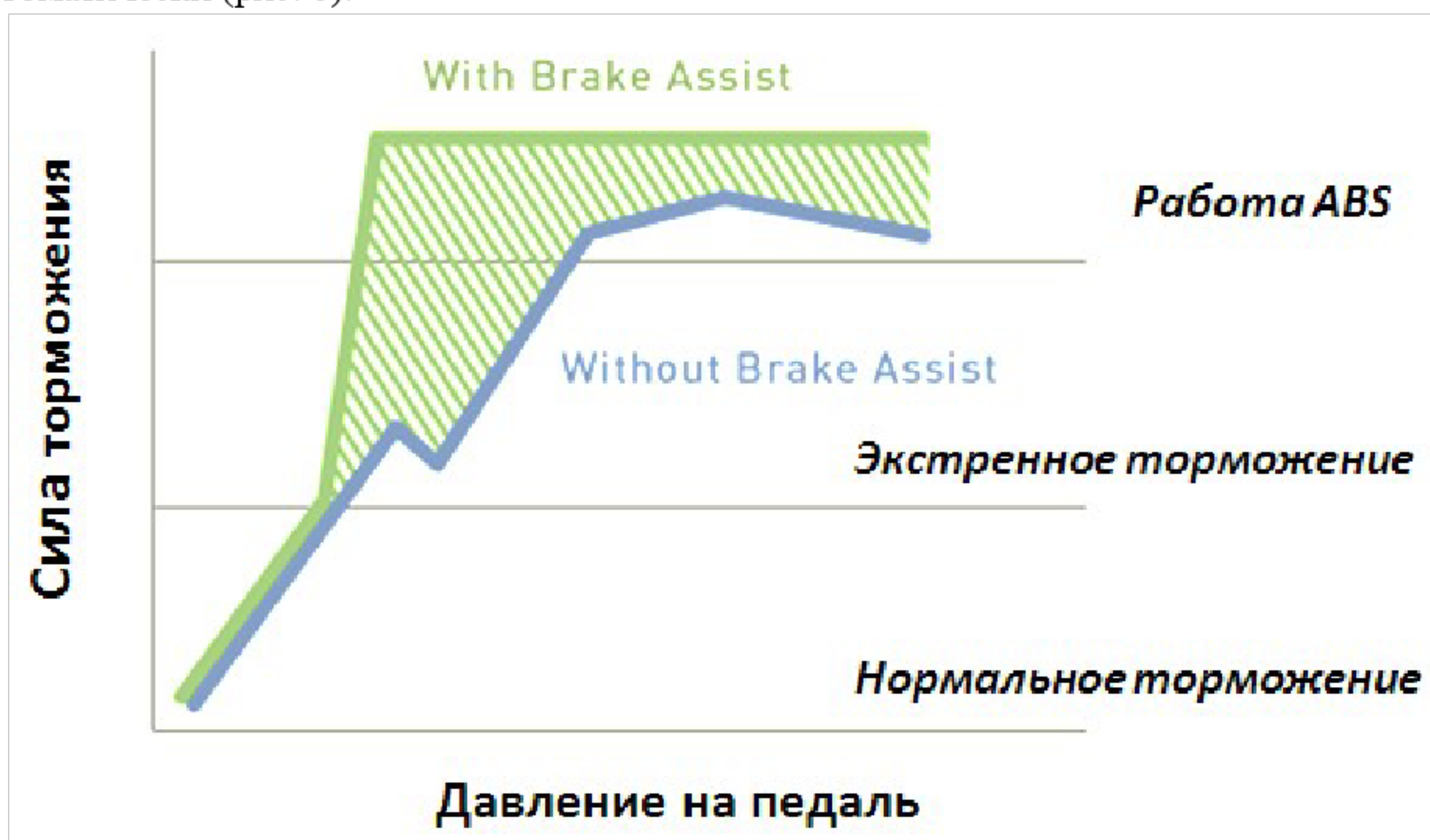
Рисунок 6 – График нарастания давления в тормозной системе с системой экстренного торможения.
