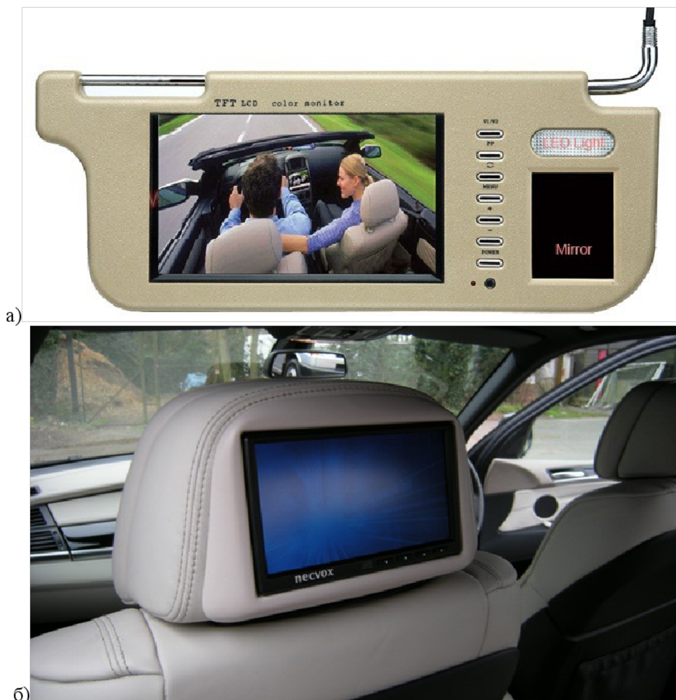
Рисунок 2 – Установка встраиваемых мониторов: а – в солнцезащитный козырёк; б - в тыльную часть подголовника.
