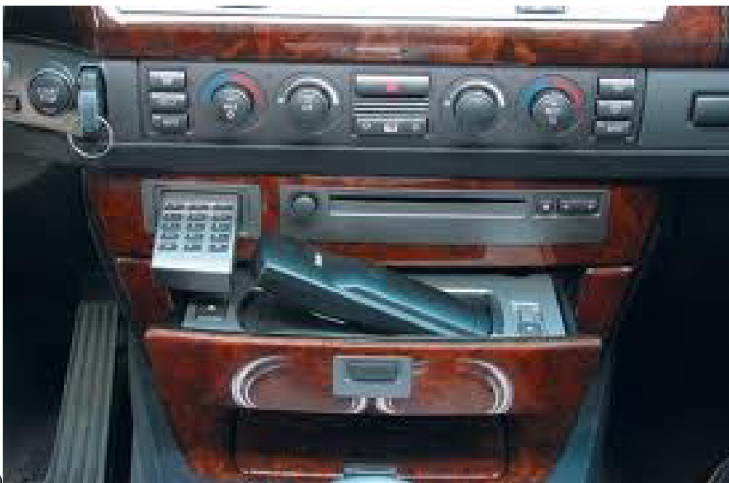
Рисунок 5 – Расположение телефонной радиотрубки: а - в подлокотнике переднего ряда сидений автомобиля BMW 7 серии e38; б – в выдвижной нише панели приборов автомобиля BMW 7 серии e65.
