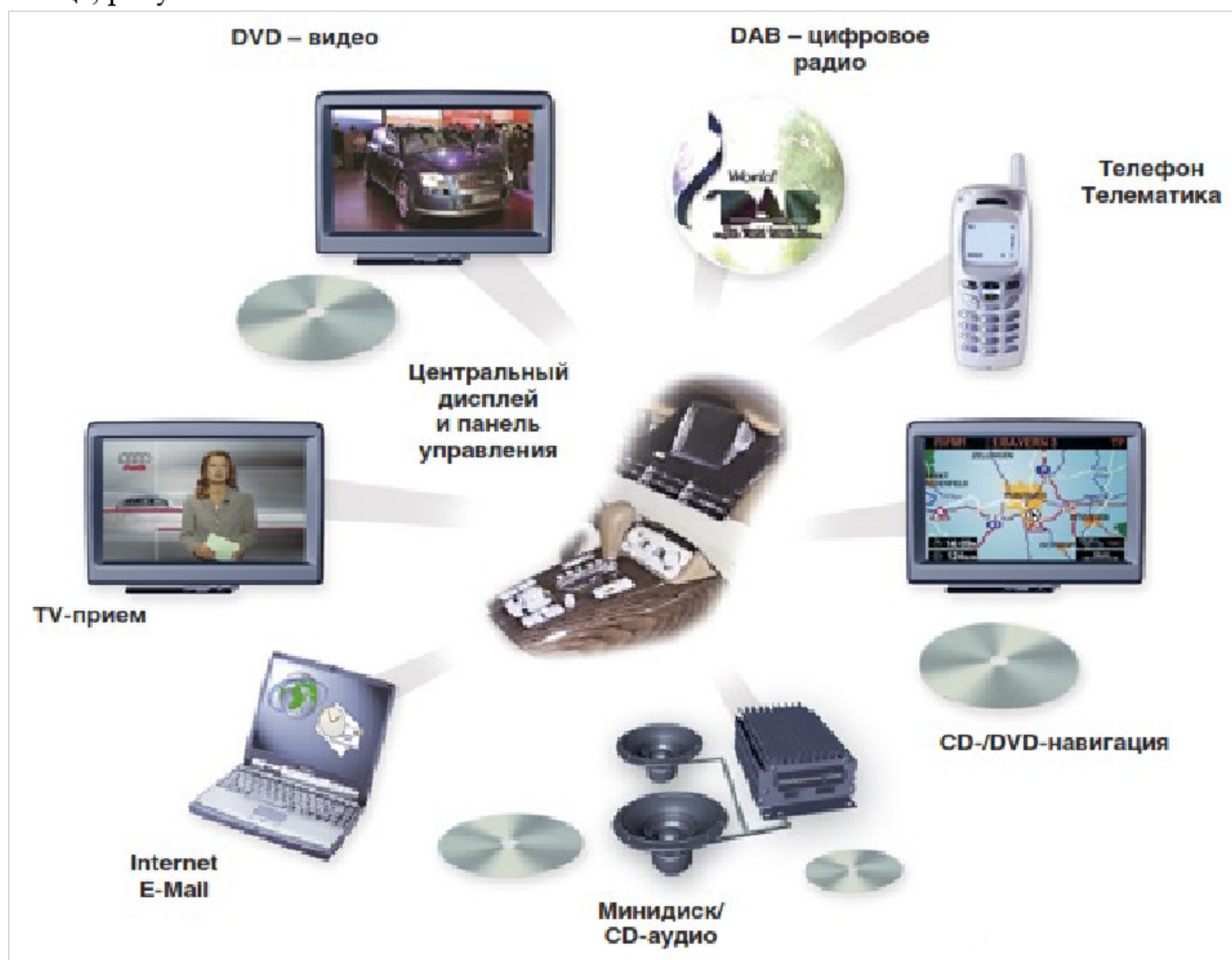
Рисунок 6 – Взаимодействие систем автомобиля по шине MOST.
