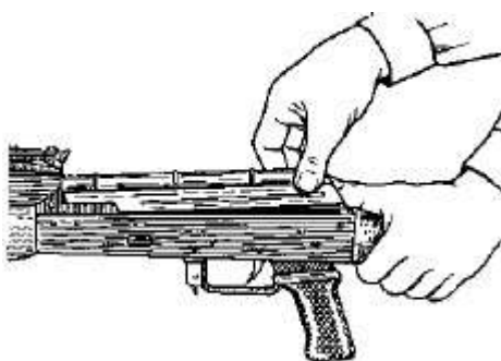
Рис. 13. Отделение крышки ствольной коробки
