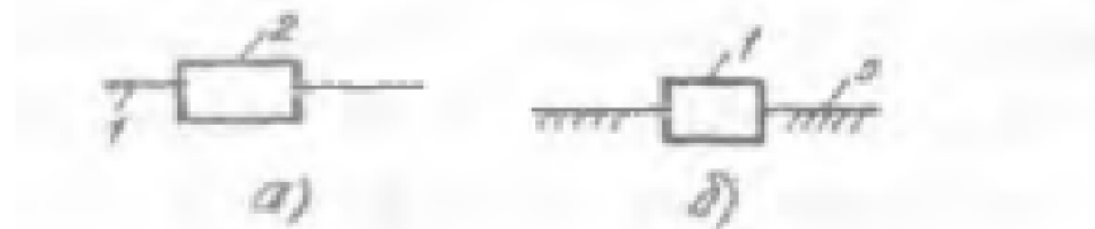
Рисунок 1.2 – Поступательные кинематические пары 5-го класса
