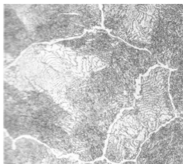
Рис. 5. Заэвтектоидная сталь с 1,2% С – перлит и цементит вторичный ( t_{500} ).
