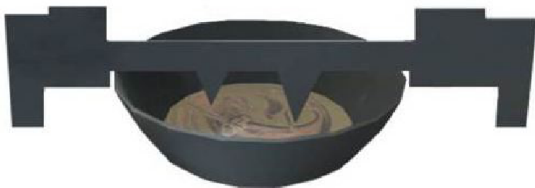
Рис. 4.1. Измерение уровня масла шаблоном
