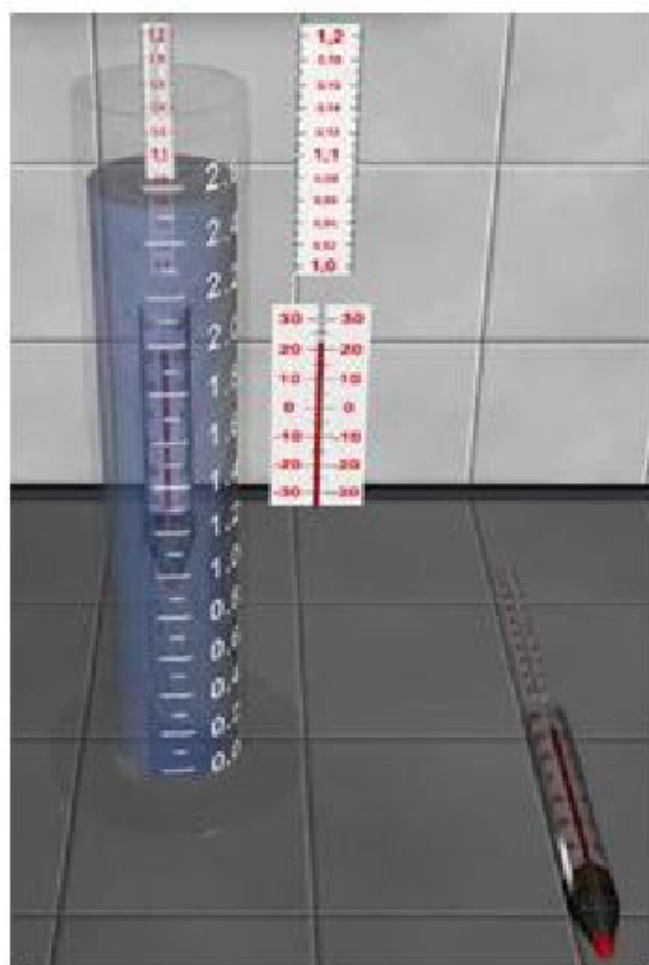
Рис. 3.4. Нефтеденсиметр в сосуде
